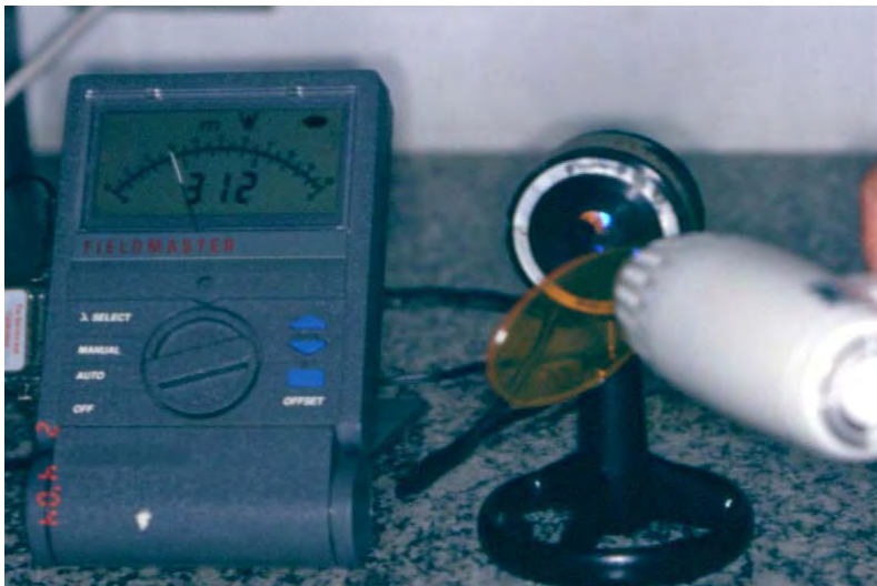
FIGURA 12 - Medida da potência do aparelho de luz halógena.
