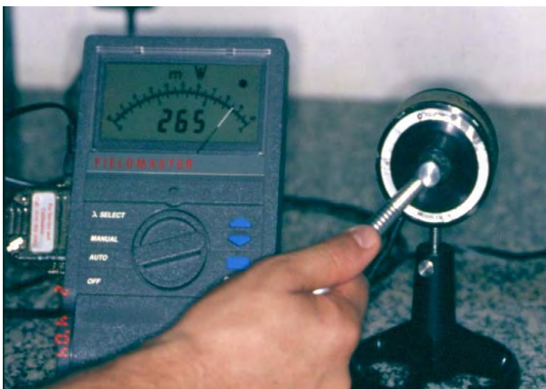
FIGURA 13 - Medida da potência do dispositivo LEDs.
