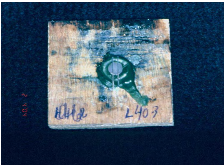
FIGURA 30 - Corte longitudinal das amostras obtendo fatia com 1,5 mm de espessura.
