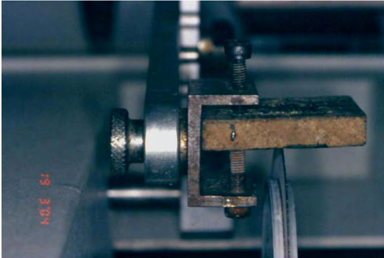
FIGURA 29 - Bloco de madeira com amostra adaptados na máquina de cortes Isomet 1000 (Buehler).
