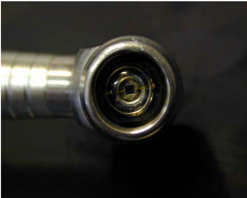
FIGURA 4 - Detalhe da ponta ativa do dispositivo à base de LEDs.
