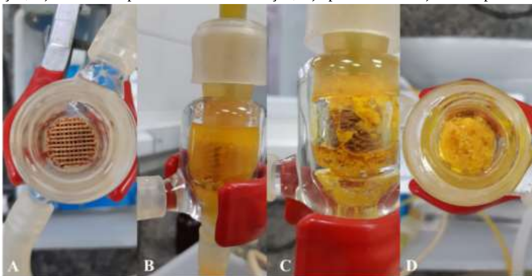
Figura 39. Reator com o biocatalisador CRL-Geo no 2º reuso matéria-prima Palma - A) Antes da reação, B) Durante as primeiras horas de reação, C) após 24 horas D) Vista superior
