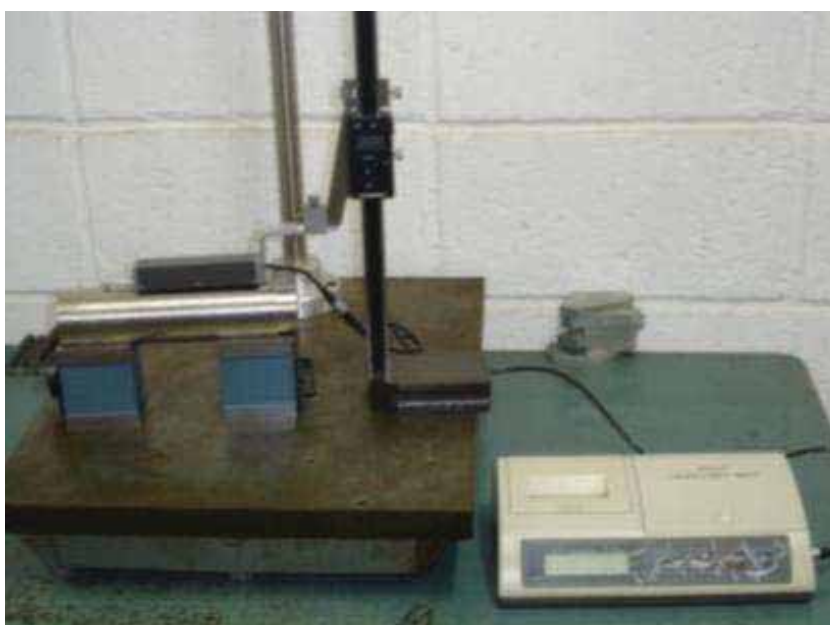
Figura 9 – Montagem do rugosímetro portátil
