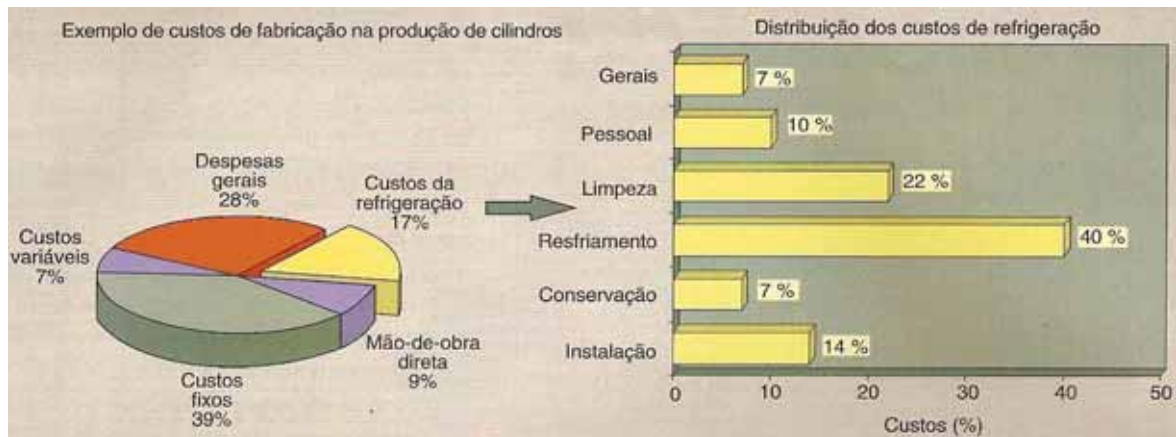
Figura 3 – Relação de custos de fabricação associados ao uso de fluido de corte, (Novaski e Dörr, 1999).
