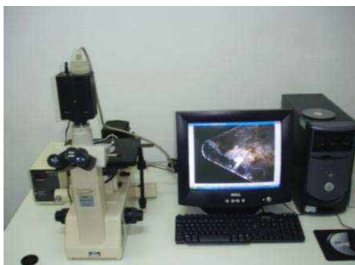
Figura 8 - Microscópio óptico acoplado a um microcomputador
