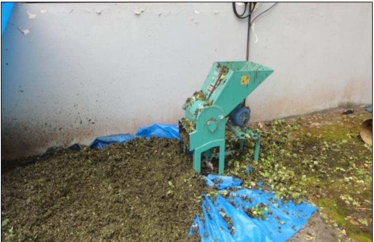
Figura 1. Material vegetal triturado pela picadora Sertaneja Master, modelo PN Plus 2000.
