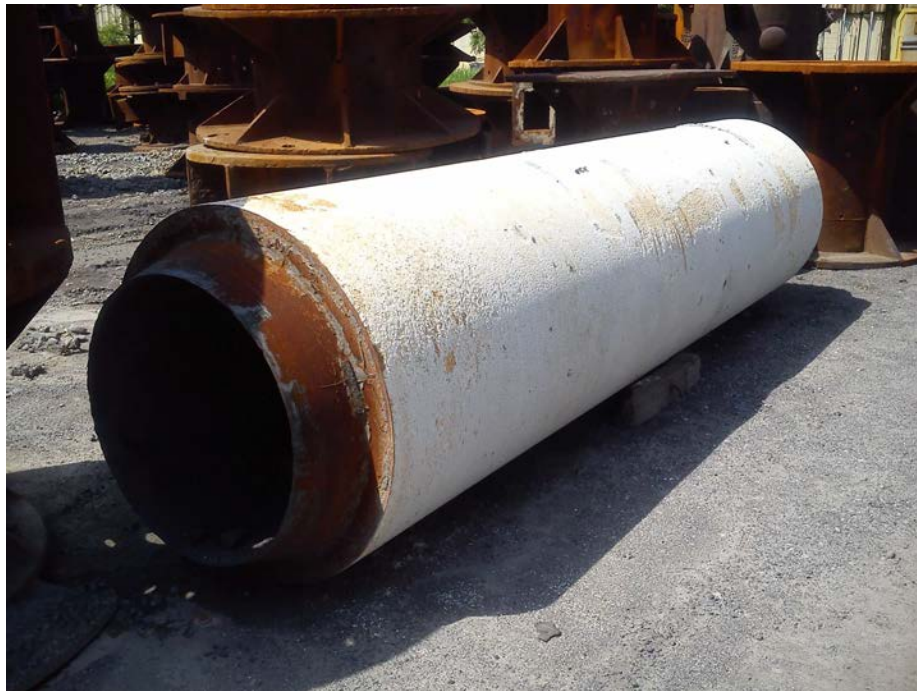
Figura 26 - Bucha teste de um cilindro de ferro fundido indefinido padrão.
