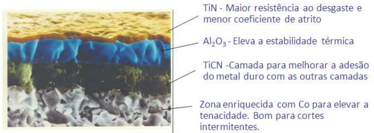
Figura 24 – MEV de um metal duro com triplo revestimento.
