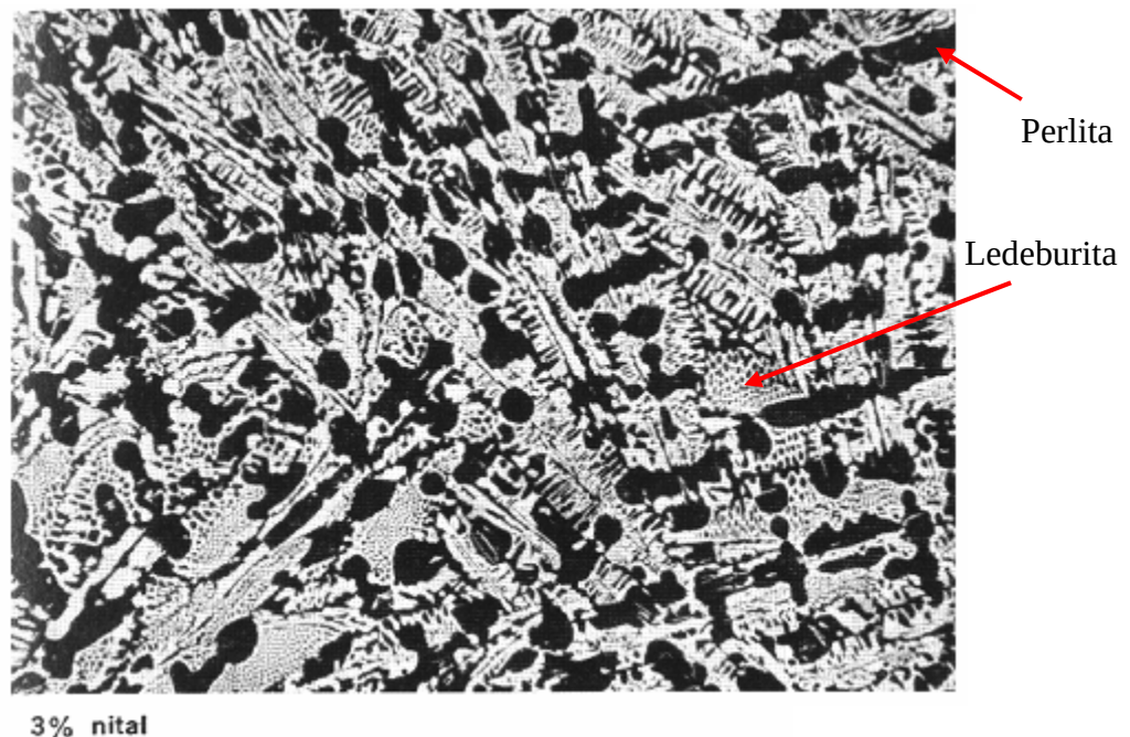
Figura 13 - Microestrutura típica de um ferro fundido branco.
