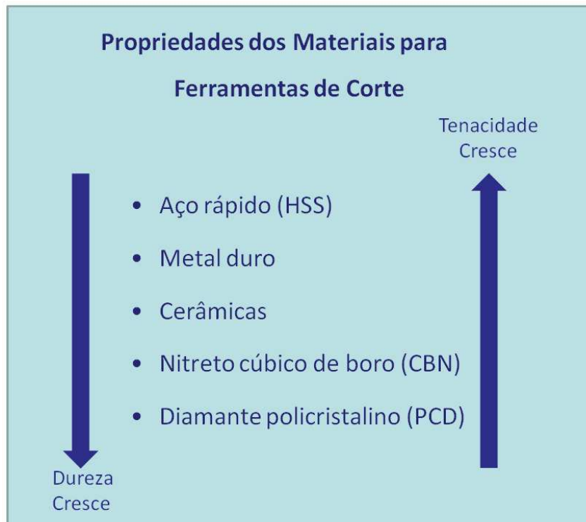
Figura 21 - A variação das propriedades dos Materiais de Ferramentas de Corte.
