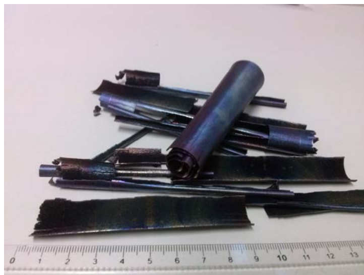
Figura 20 - Cavacos de ruptura obtidos na usinagem de cilindro de laminação.
