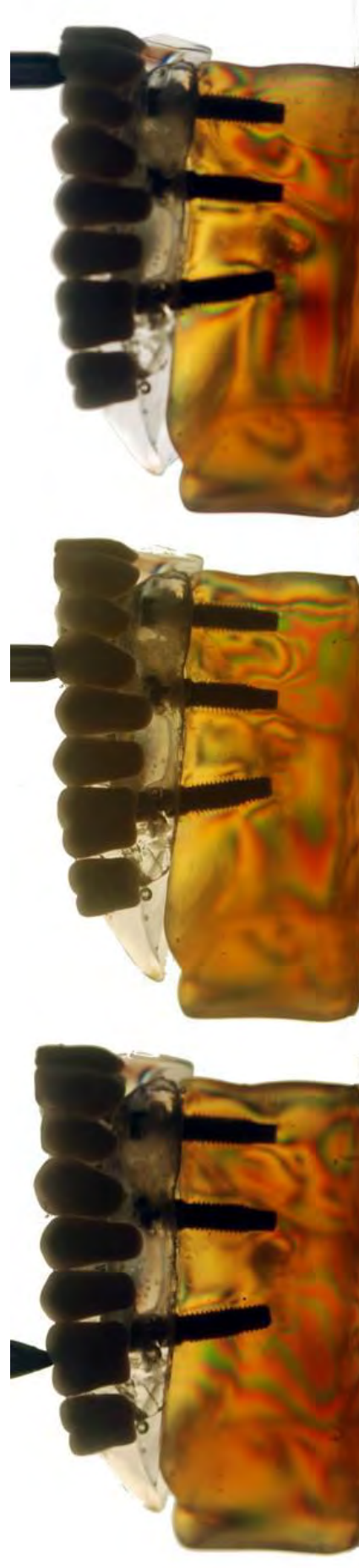
Figura 3: Distribuição das tensões nos modelos com sistema de retenção com três O-rings individualizados (OR).
