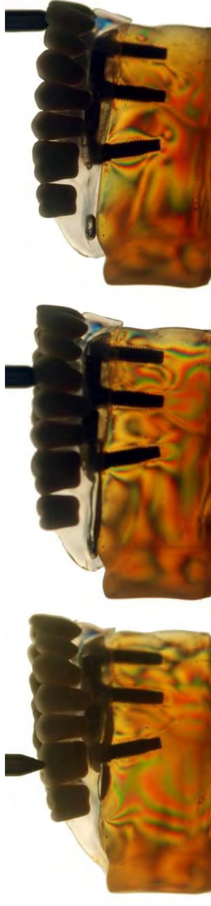
Figura 6: Distribuição das tensões nos modelos com sistema de retenção Barra-clip (BC).
