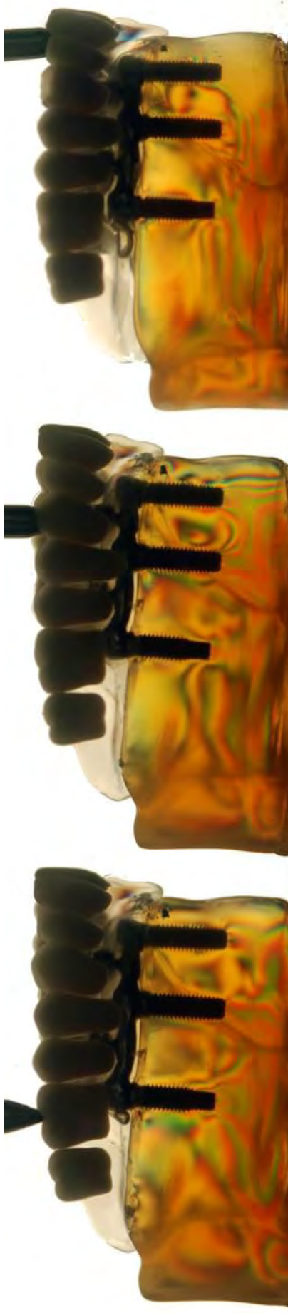
Figura 4: Distribuição das tensões nos modelos com sistema de retenção com implantes esplintados por meio de barra associados a dois O-rings posicionados no centro da barra (BOC).
