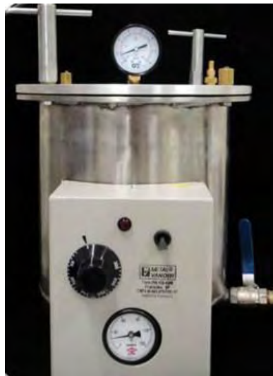
Figura 11: Polimerizadora de resina, utilizada para remoção de bolhas internas da resina fotoelástica.
