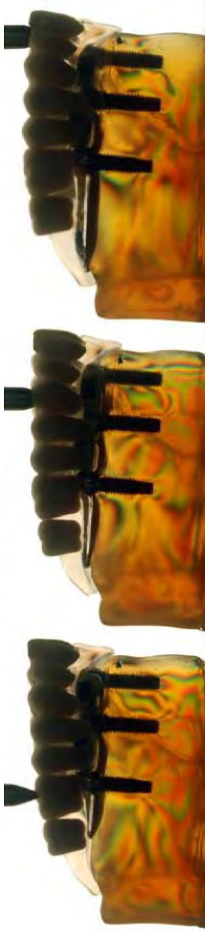
Figura 6: Distribuição das tensões nos modelos com sistema de retenção Barra-clip (BC).
