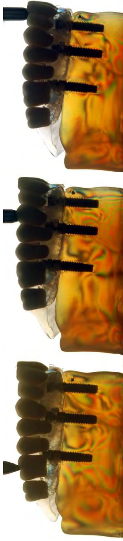
Figura 3: Distribuição das tensões nos modelos com sistema de retenção com três O-rings individualizados (OR).
