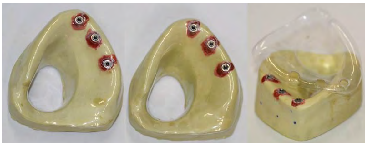
Figura 12: Sobre os modelos padrão de gesso tipo IV, foi posicionada uma placa de acetato com espessura de 1 mm, com o auxílio de um plastificador térmico a vácuo (Plastivac – P7, Bio-Art, São Carlos, São Paulo, Brasil), que representará a fibromucosa do paciente.
