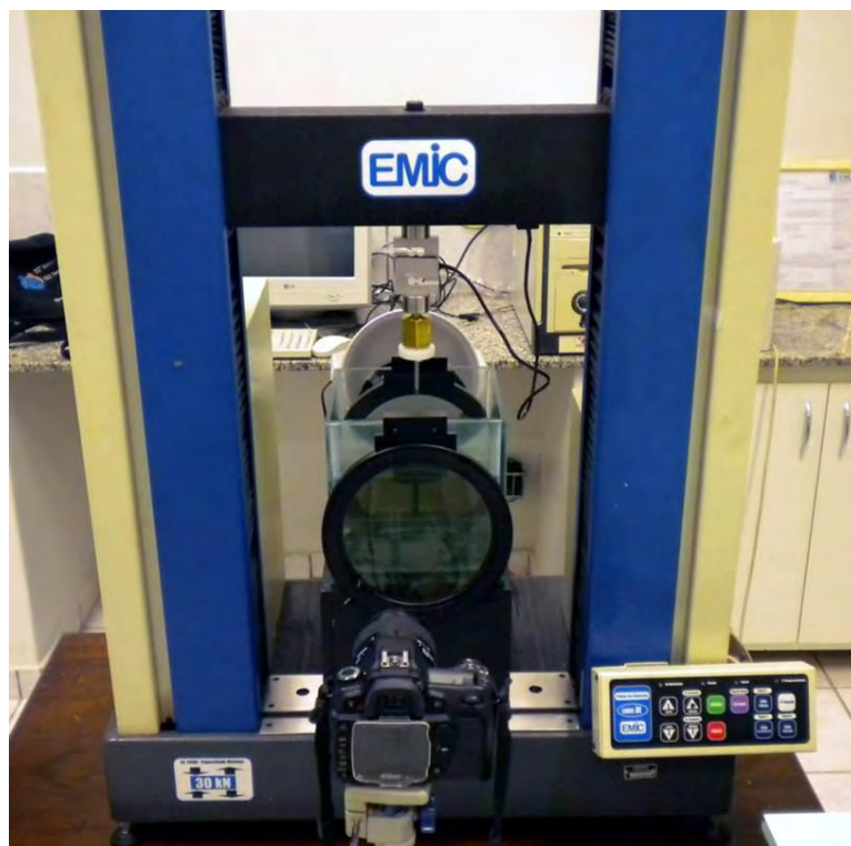
Figura 16: Conjunto para aplicação de carga composto pelo polariscópio circular (Eikonol, São Paulo, São Paulo, Brasil), máquina de ensaio universal (EMIC DL-3000, São José dos Pinhais, Paraná, Brasil) e máquina fotográfica digital (Nikon D-80, Nikon Corporation, Chitoda-Ku, Tokyo, Japão).
