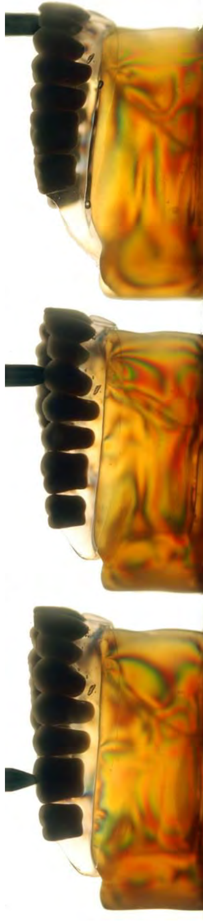
Figura 2: Distribuição das tensões nos modelos sem implantes (SI).
