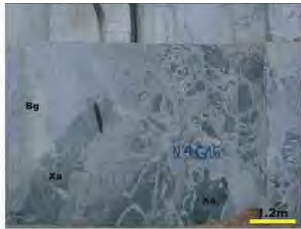
Frente de Lavra do nível 4, próximo ao Paredão Nordeste da Pedreira com grandes xenólitos de anfibolito (Xa1) inserido no contexto de seu arcabouço litológico (Bg).
