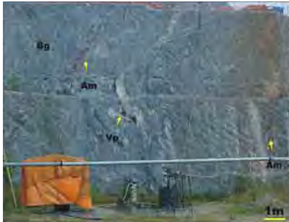
Frente de Lavra dos níveis 4 e 3 na posição centro suldeste da pedreira com destaque para a litologia principal Biotita Gnáisse migmatítico (Bg) e subordinadamente veios pegmatíticos (Vp) e diques boundinados de anfibolito metassomático (Am).
