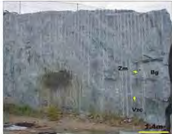
Frente de Lavra do nível 2 com predominância de Biotita Gnáisse Migmatítico ocorrendo litotipos menores, tais como; veios migmatíticos de zonas de cisalhamento (Vzc), zonas migmatíticas (Zm).
