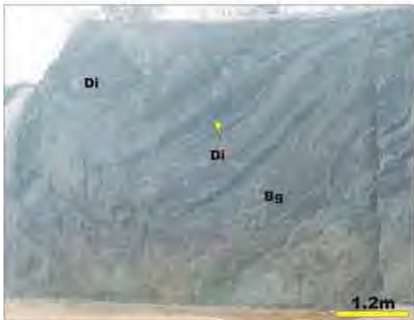
Frente de Lavra do nível 4, localizada a noroeste da Pedreira com camadas de rochas máficas "diorito" (Di).
