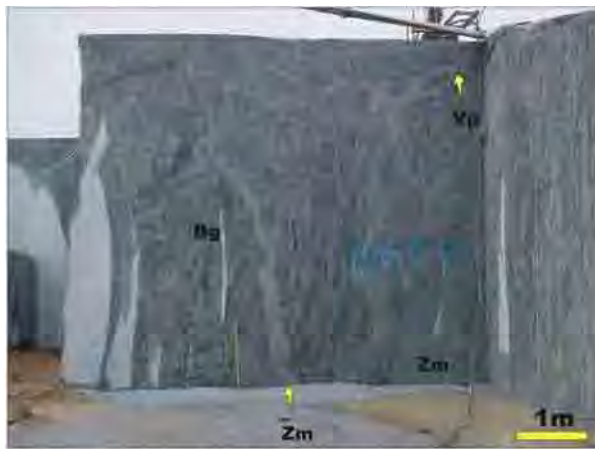
Frente de Lavra do nível 5 da pedreira "Knawa", com predominância de Biotita Gnáisse migmatítico (Bg) e subordinadamente zonas migmatíticas (Zm) e veios pegmatíticos (Vp).
