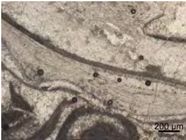
FM 42: Microestrutura foliada de bivalve em grainstone bioclástico da Formação Jandaíra. Lâmina J-44-A. Lajedo de Soledade (coord. UTM 9400150/659520). Nicóis paralelos.
