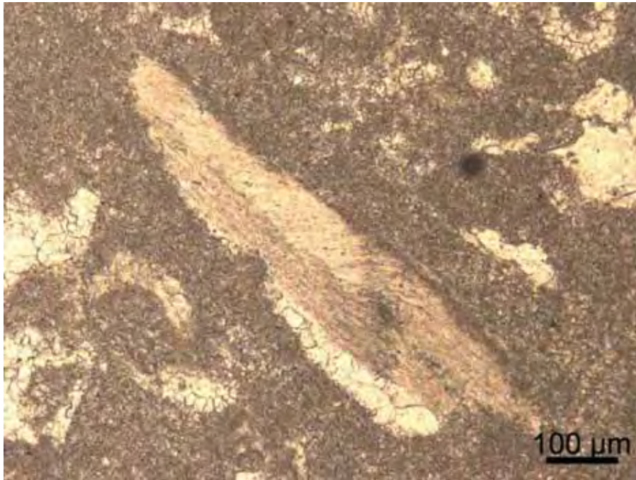
FM 17: Fragmento de bivalve, mostrando microestrutura cruzada-lamelar. Parte superior da Formação Ponta do Mel. Nicóis paralelos.
