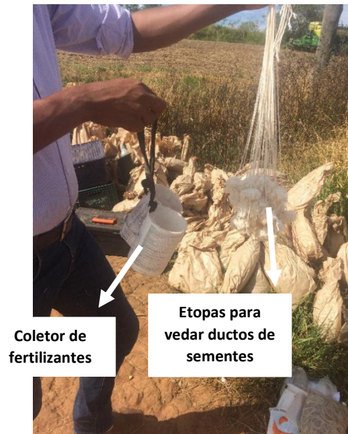
Figura 10 - Materiais utilizados para vedar os ductos condutores das sementes e copos de polietileno para coletar o fertilizante nas linhas de semeadura.
