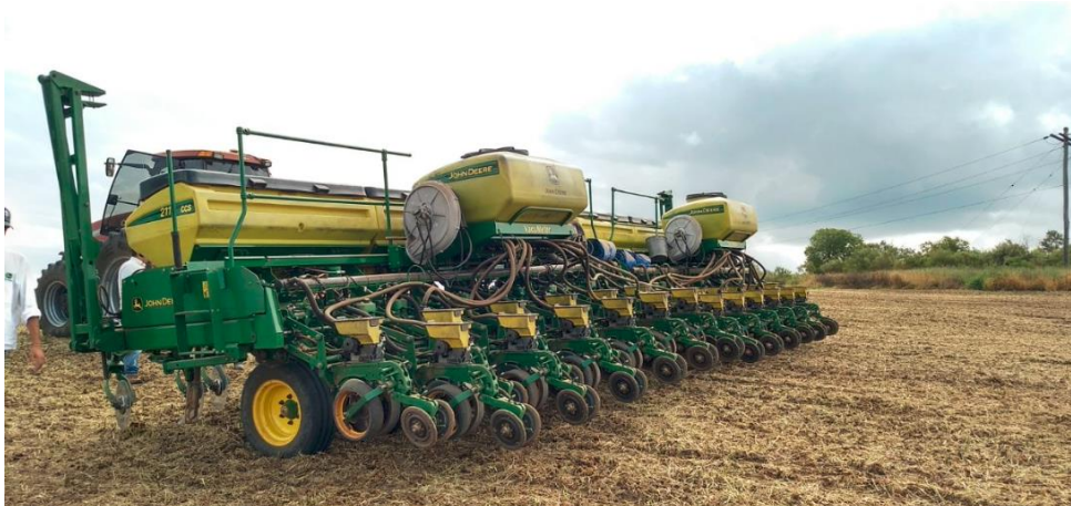
Figura 5 - Semeadoras de precisão à vácuo John Deere 2113 unidas por tandem para semeadura do milho.
