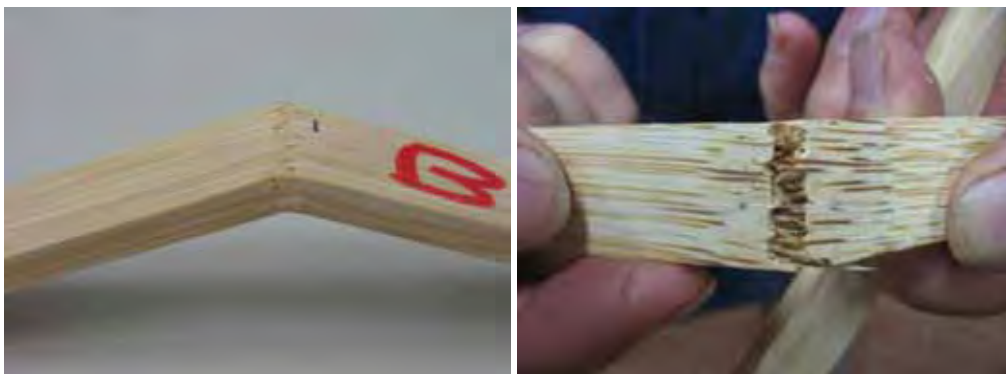
Figura 44 – Corpos de prova de flexão estática após a realização do ensaio
