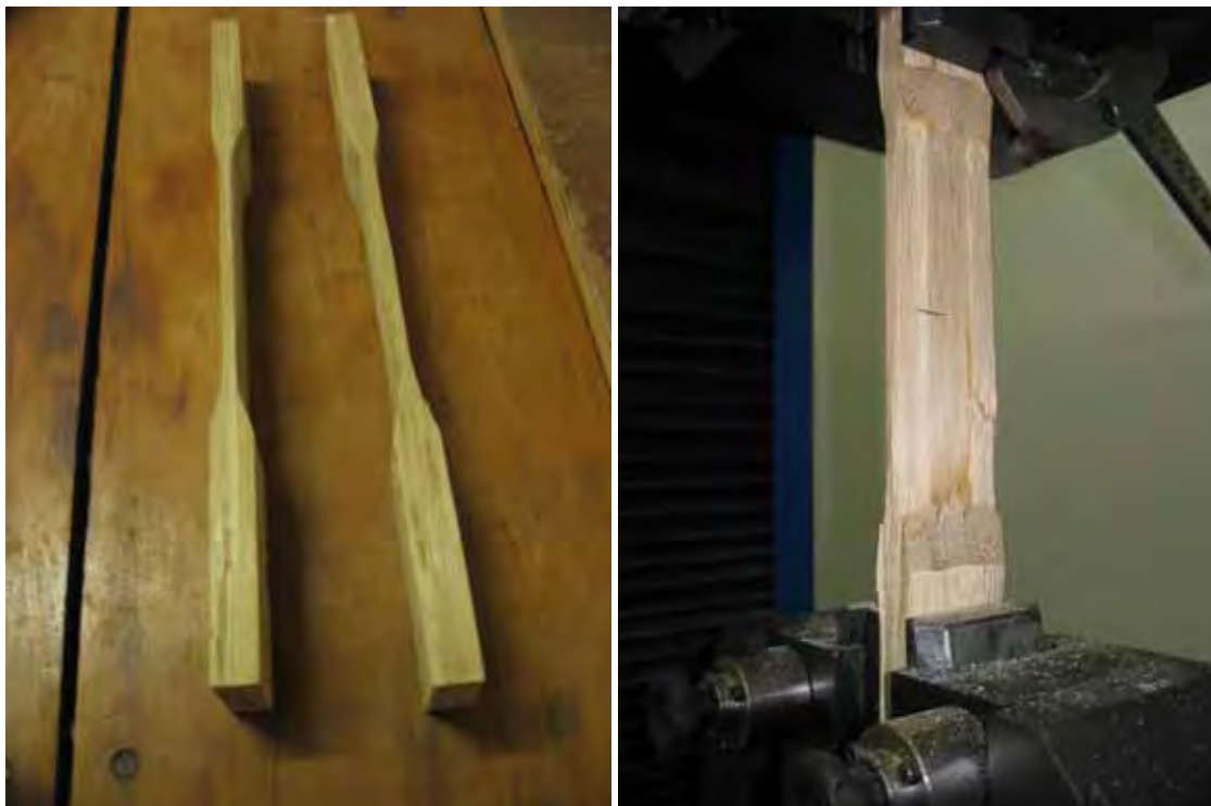
Figura 59 – Corpo de prova de tração paralela às fibras e respectivo ensaio após retirada do extensômetro.
