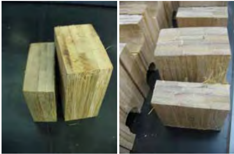
Figura 67 – Corpo de prova após o rompimento
