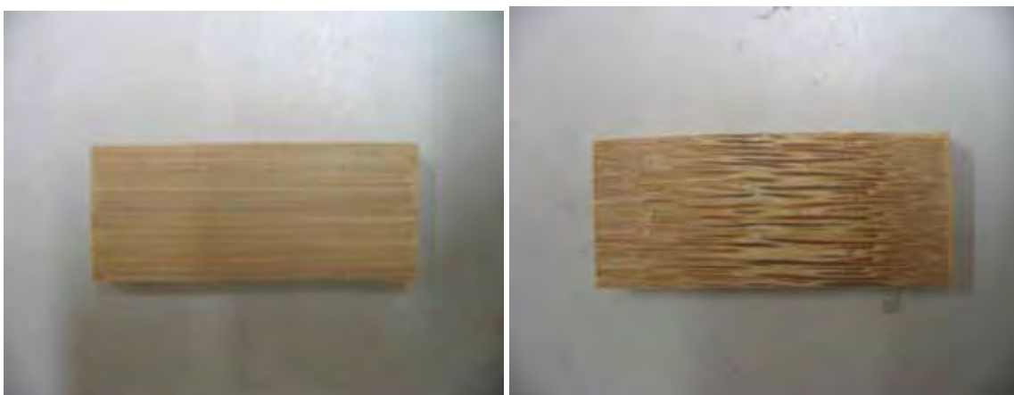
Figura 36 – Corpos de prova. Estabilidade dimensional: sem nó (esquerda), com nó (direita).
