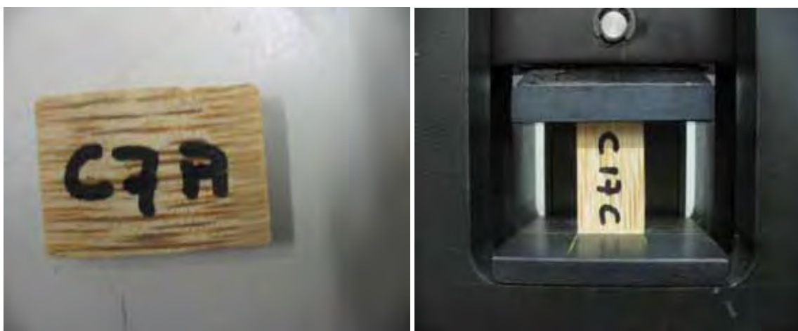
Figura 40 - Corpo de prova de compressão e respectivo ensaio.
