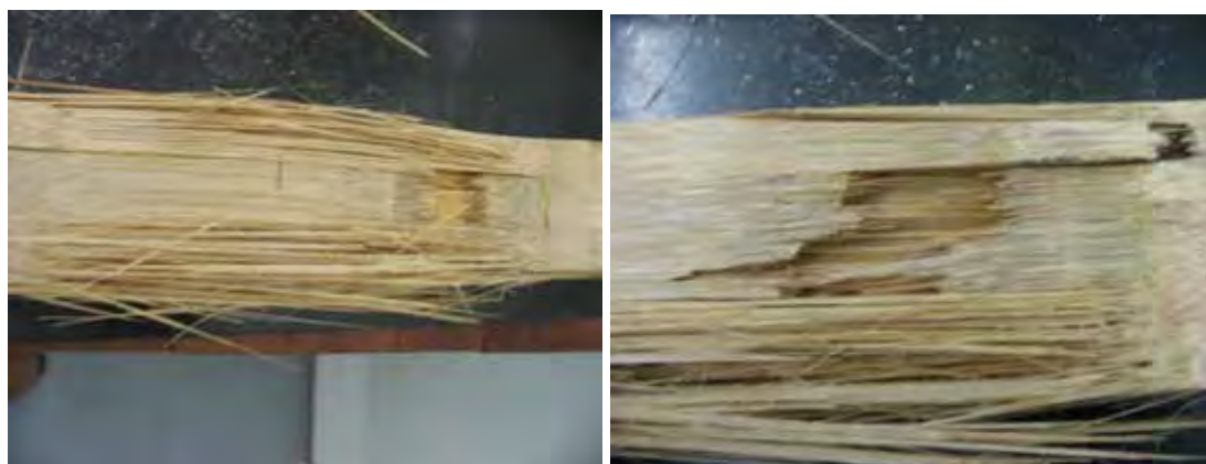
Figura 60 – Corpos de prova de tração paralela às fibras após a realização do ensaio.
