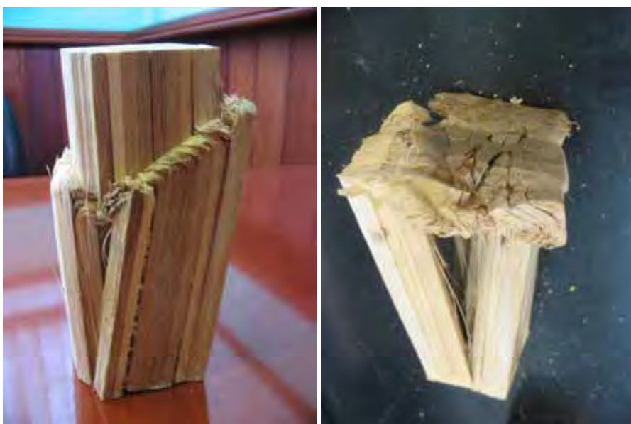
Figura 56 – Corpos de prova de compressão paralela às fibras após a realização do ensaio.
