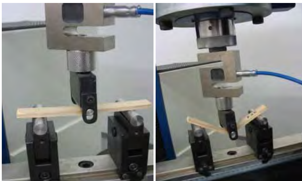
Figura 43 - Corpo de prova de flexão e respectivo ensaio.
