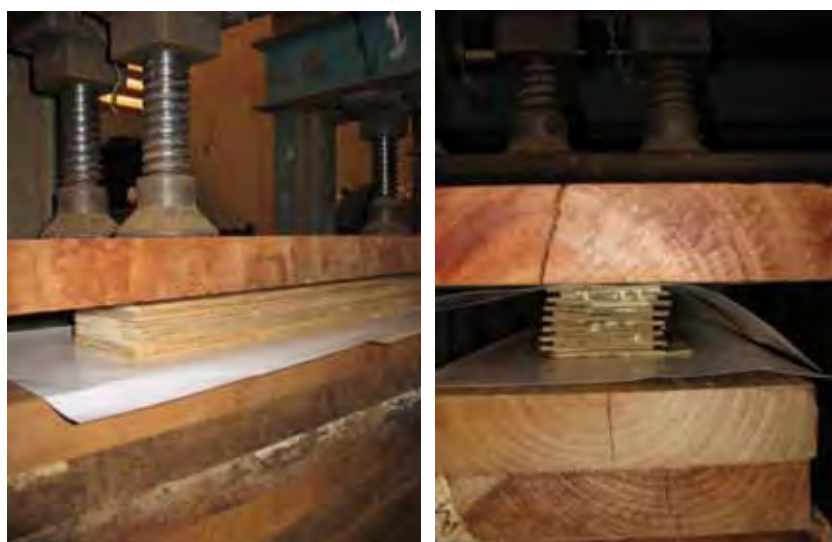
Figura 9 - Equipamento para a colagem em espessura das ripas
