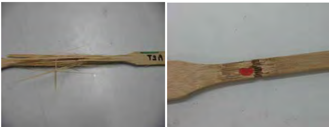
Figura 48 – Corpos de prova de tração após a realização do ensaio
