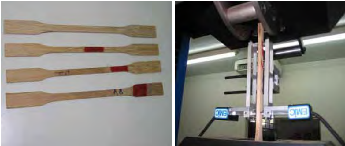
Figura 47 - Corpo de prova de tração e respectivo ensaio, mostrando extensômetro
