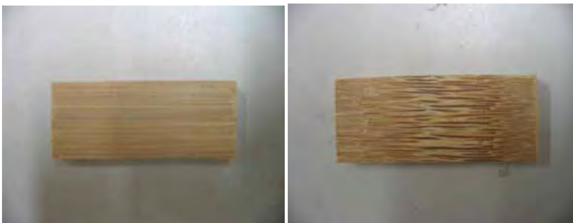
Figura 32 – Corpos de prova para massa específica: sem nó (esquerda), com nó (direita)
