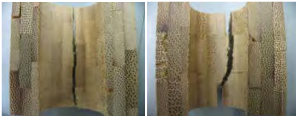
Figura 64 – Corpo de prova após o rompimento
