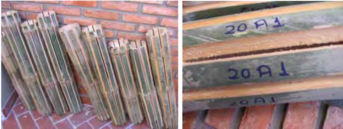
Figura 27 - Feixes de ripas oriundas do desdobro longitudinal e identificação utilizada.
