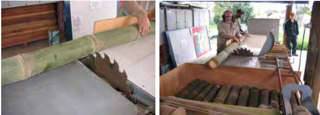
Figura 25 – Operação de desdobro ou corte perpendicular
