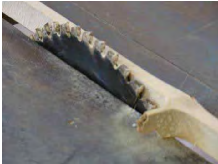
Figura 5, Serra circular para a retirada dos nós
