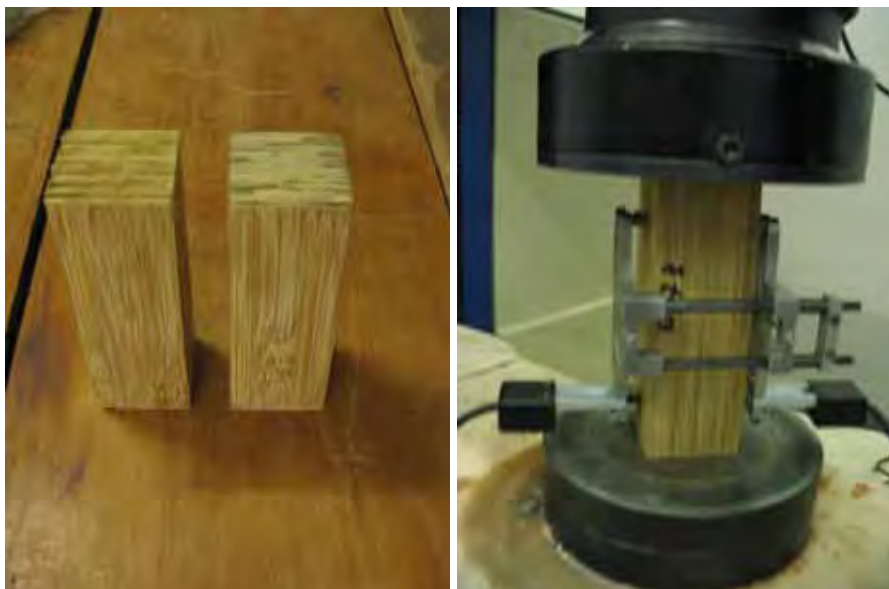
Figura 55 – Corpo de prova de compressão paralela às fibras e respectivo ensaio mostrando o extensômetro.
