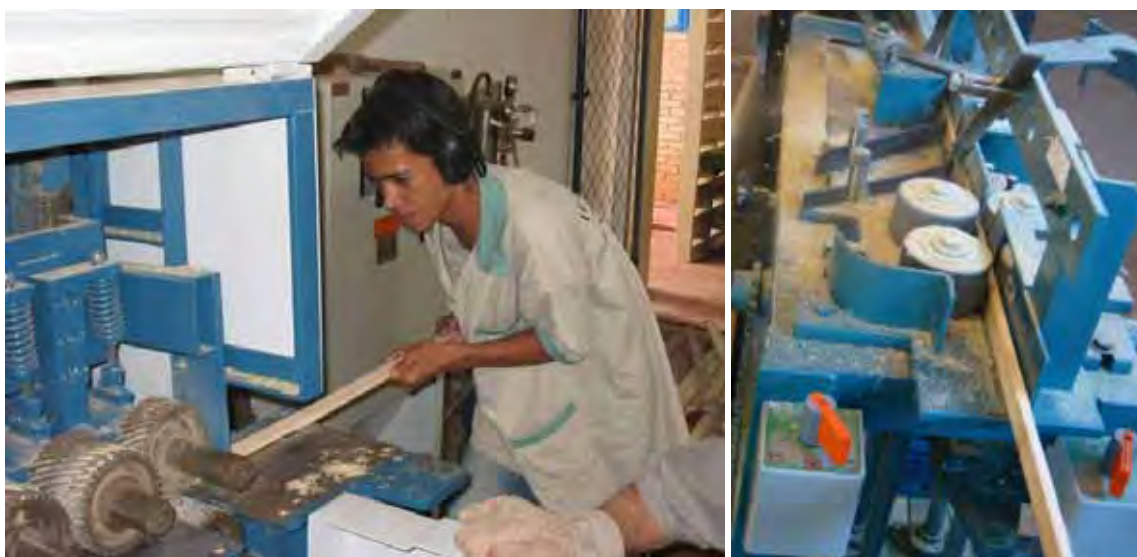
Figura 30. Processamento final das ripas em plainas quatro faces e plaina duas faces
