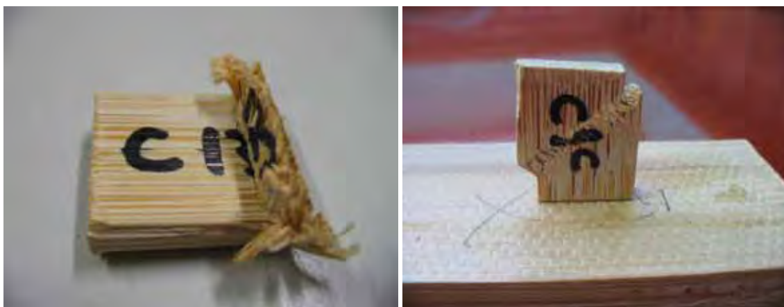
Figura 41 – Corpos de prova de compressão após a realização do ensaio
