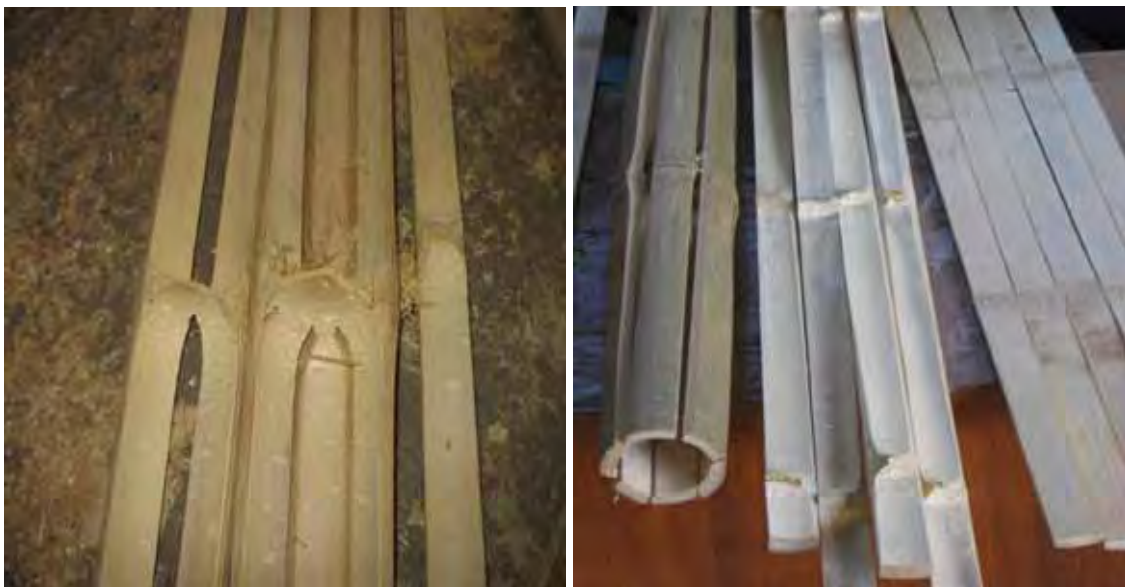
Figura 28 – Aspecto das ripas após separação do feixe, mostrando os nós internos.
