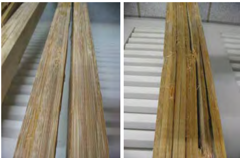
Figura 58 – Corpos de prova de flexão estática após a realização do ensaio.
