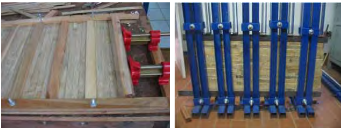
Figura 8 – Equipamento para colagem lateral das ripas
