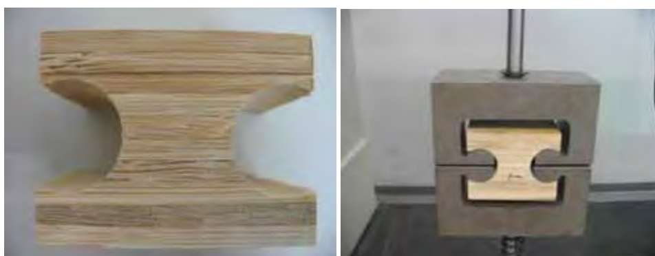
Figura 63-A – Corpo de prova para tração paralela às fibras na lâmina de cola e respectivo ensaio
