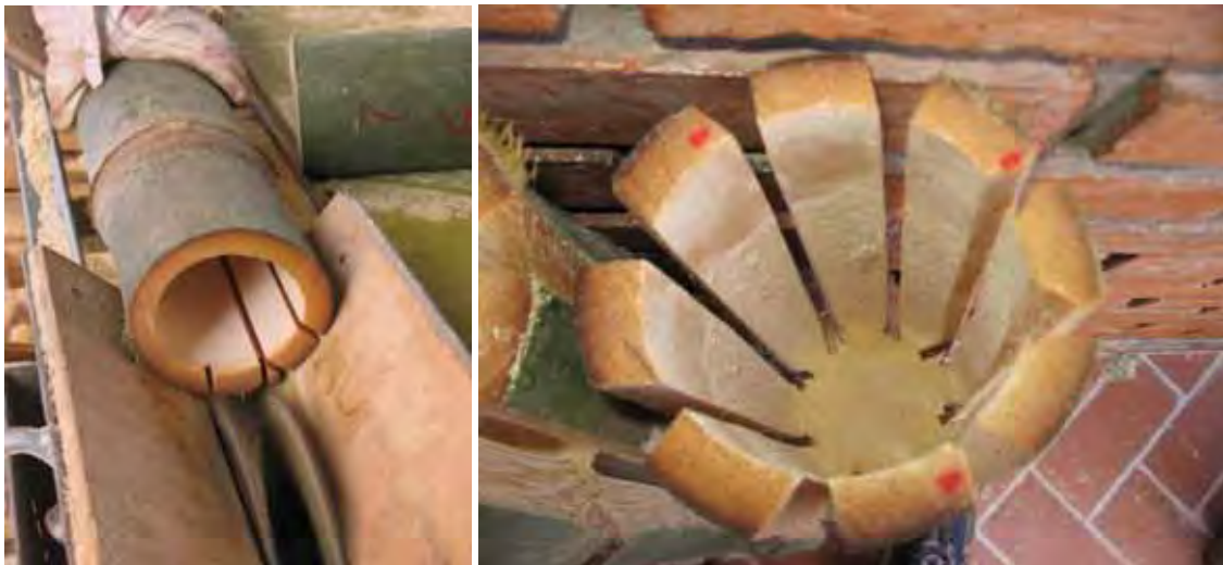
Figura 26 - Operação de corte longitudinal e aspecto das ripas ainda não destacadas
