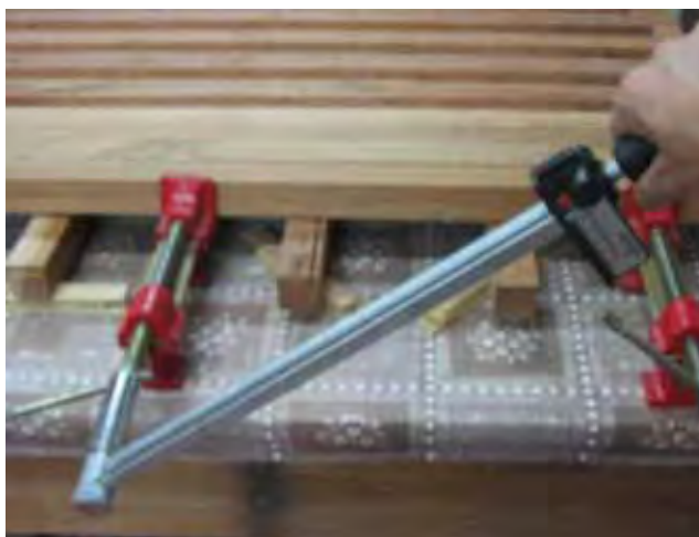
Figura 53–Utilização de torquímetro para controlar a pressão na colagem dos laminados.
