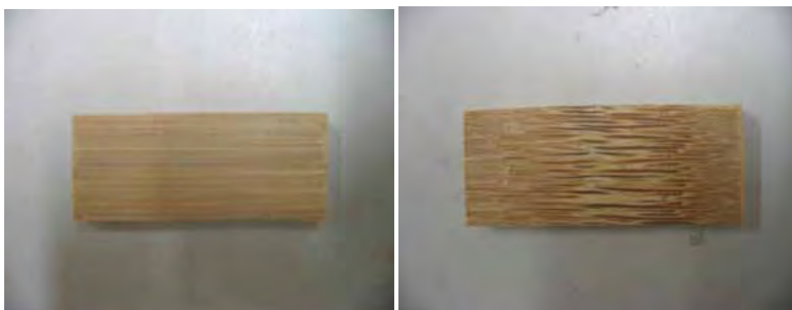
Figura 34 – Corpos de prova para absorção de água : sem nó (esquerda), com nó (direita)
