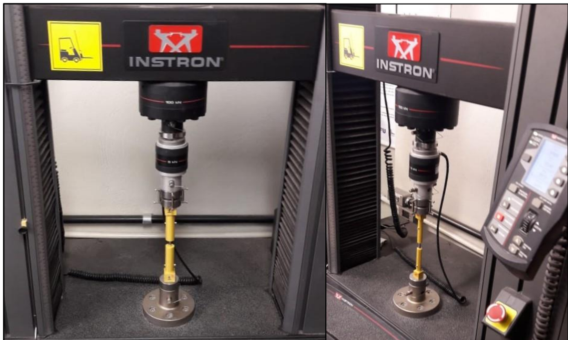
Figura 8A: Imagens realizadas durante os testes com os corpos de provas de 7 mm (esquerda) e 3 mm (direita), na máquina de ensaio universal Instron modelo 5982 com deslocamento padronizado em 5 mm/min.
