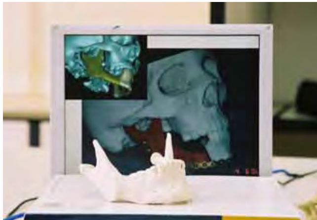
Figura 11: Exemplo de Prototipagem rápida a partir de modelos virtuais (Fonte: BCS Tecnologia, 2007).
