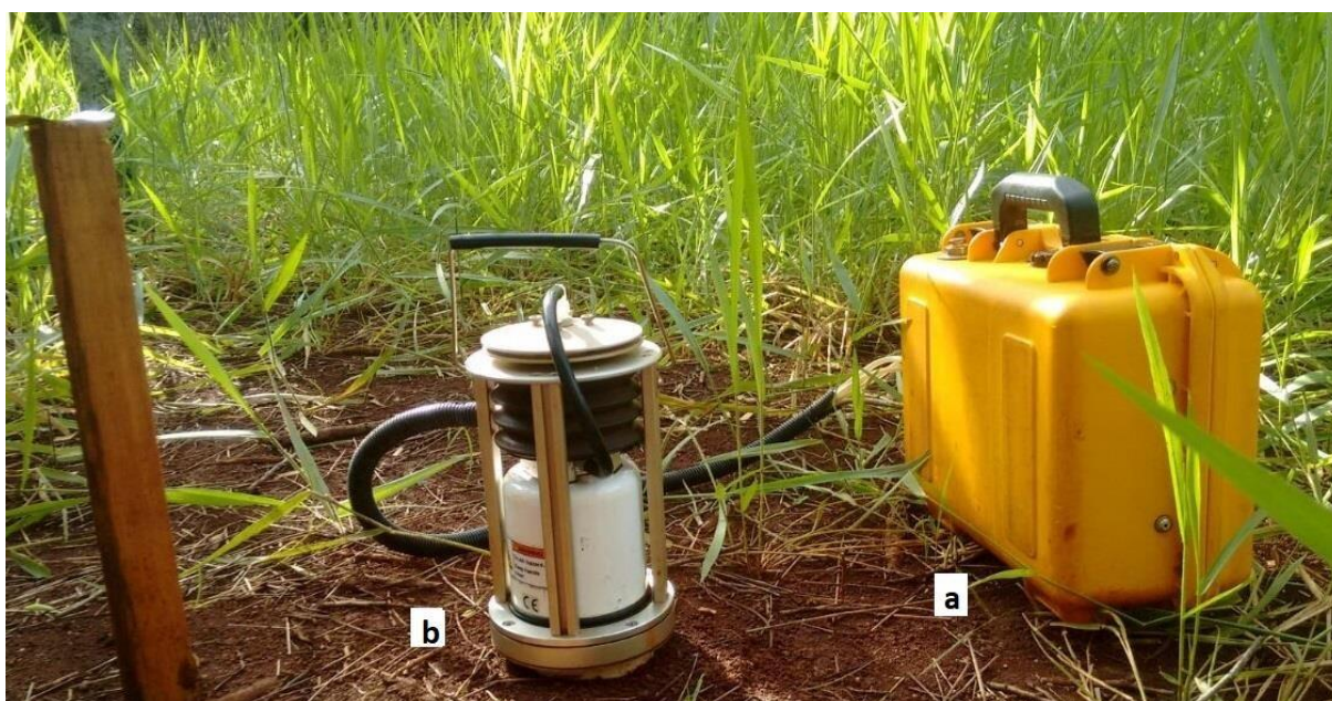
Figura 3- Sistema LI-8100 interligado à câmara de solos (a), e câmara para solo inserida sobre o colar de PVC (b).
