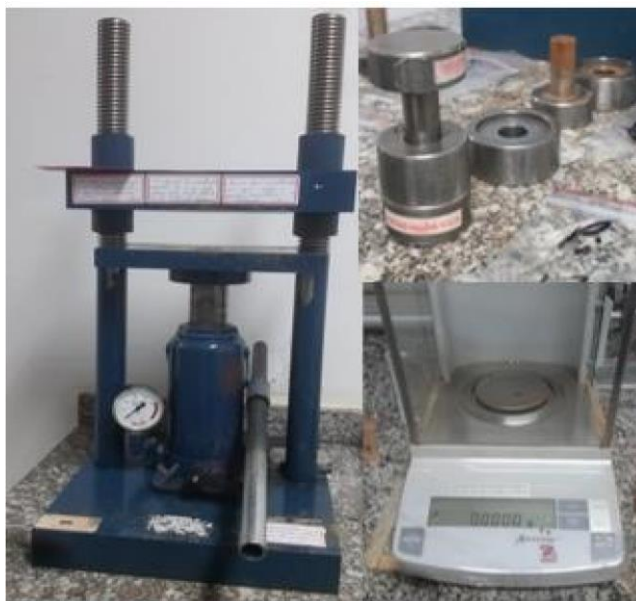
Figura 9 – Prensa hidráulica, e balança de precisão utilizada na elaboração das pastilhas.
