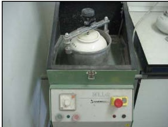
Figura 8- Equipamento: Moinho de Bolas.
