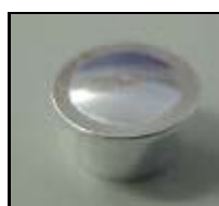
Figura 11- Crisol de alumínio.
