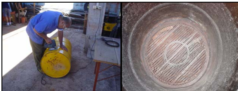
Figura 2- Etapas da construção do forno utilizado para a produção da CCA.
