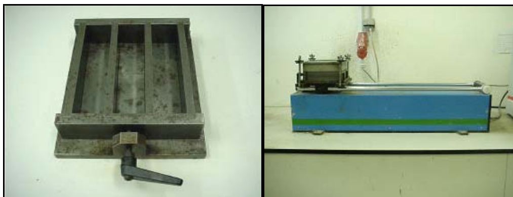
Figura 13- Molde para a preparação dos corpos-de-prova e mesa compactadora.
