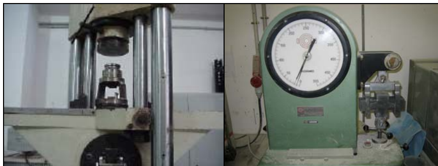
Figura 14- Prensas utilizadas nos ensaios de resistência à compressão e à flexão, respectivamente.
