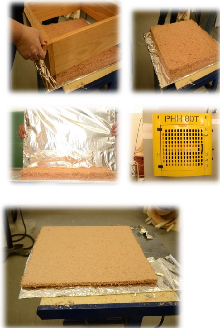
Figura 8- Retirada da caixa modeladora, painel sendo colocado entre placas metálicas e levado à prensa.
