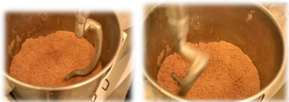
Figura 6- Mistura do adesivo às partículas utilizando o Misturador Orbital
