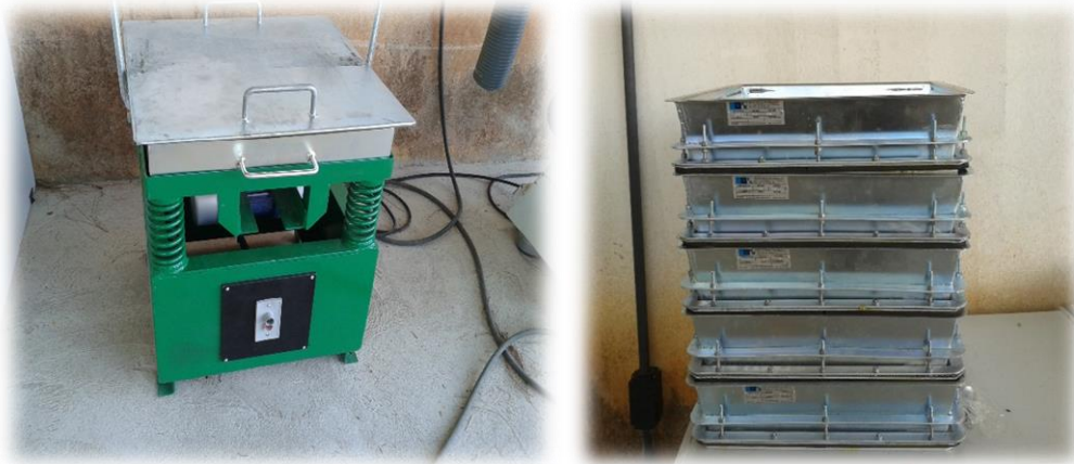
Figura 3- Agitador de peneiras e peneiras acopladas com 4 granulometria diferentes para a classificação das partículas
