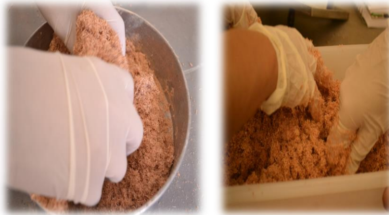
Figura 5- Mistura manual de adesivo às partículas
