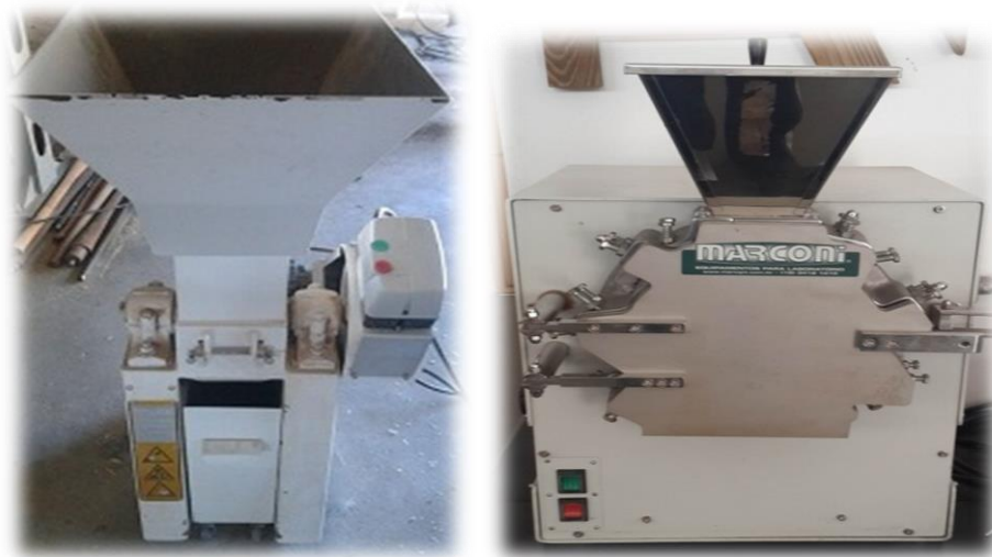
Figura 2- Picador laboratorial para processamento primário e moinho tipo willey para processamento secundário
