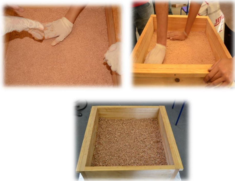
Figura 7- Partículas sendo distribuídas e compactadas até a formação do colchão
