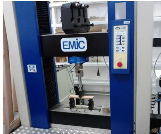
Figura 9- Ensaio de Flexão Estática em painel particulado de madeira.
