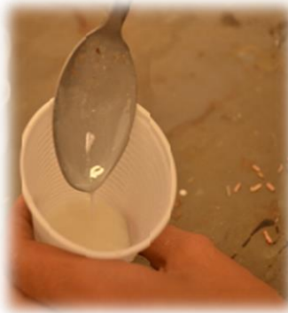
Figura 4- Mistura do adesivo, parafina, catalisador e água.
