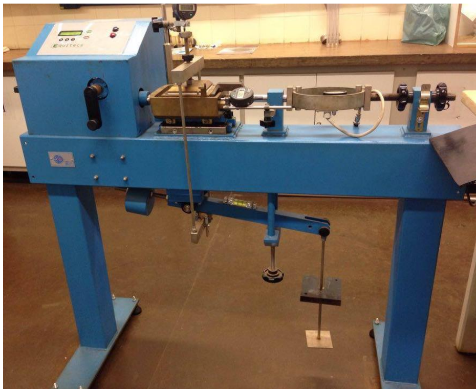
Figura 11. Equipamento utilizado para os ensaios de cisalhamento direto.
