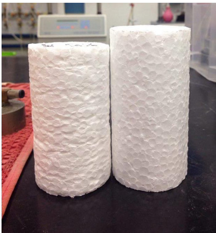
Figura 60. Comparação entre um corpo de prova não ensaiado e um que não sofreu perda de estabilidade lateral.
