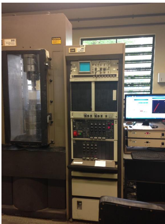
Figura 16. Equipamento utilizado no ensaio de compressão cíclica.
