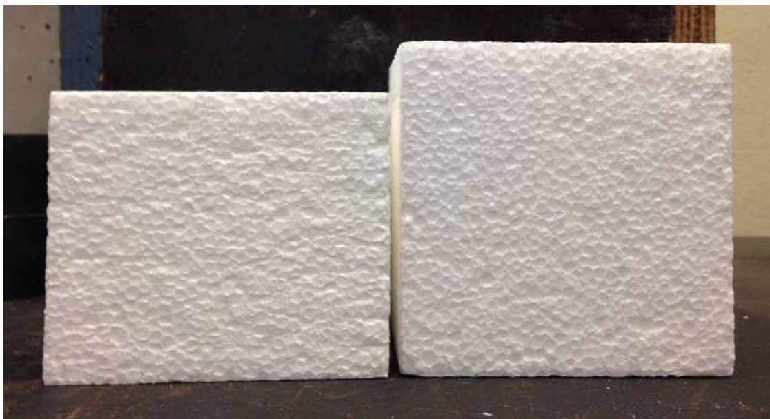
Figura 72. Comparação de corpos de prova ensaiados e não ensaiados no ensaio de compressão cíclica.
