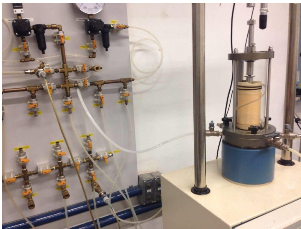
Figura 12. Detalhe da câmara de ensaios triaxiais.
