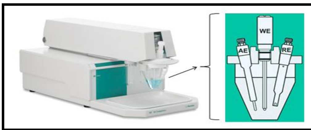
Figura 29 - Processador voltamétrico modelo 797 VA (Metrohm) e célula eletroquímica constituída por três eletrodos.
