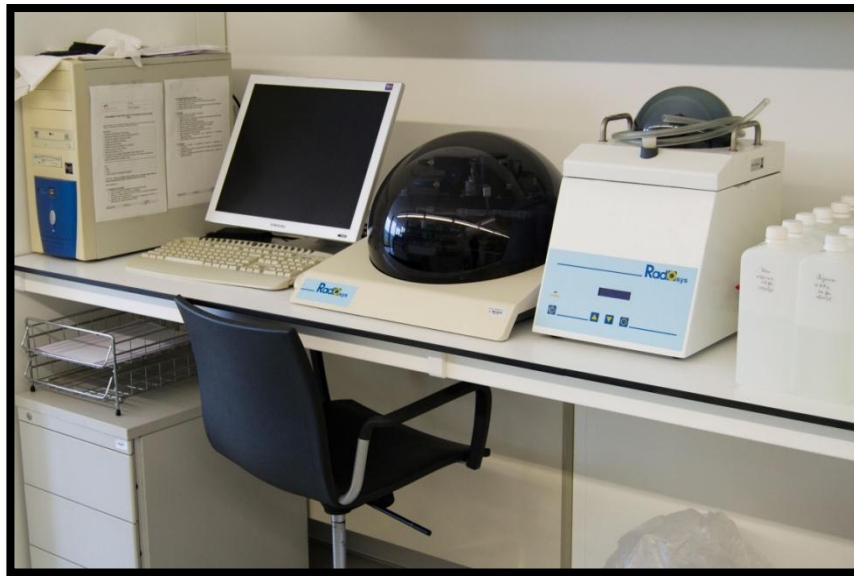
Figura 26 - Equipamento da marca RADOSYS, modelo Radometer 2000 RSV10.
