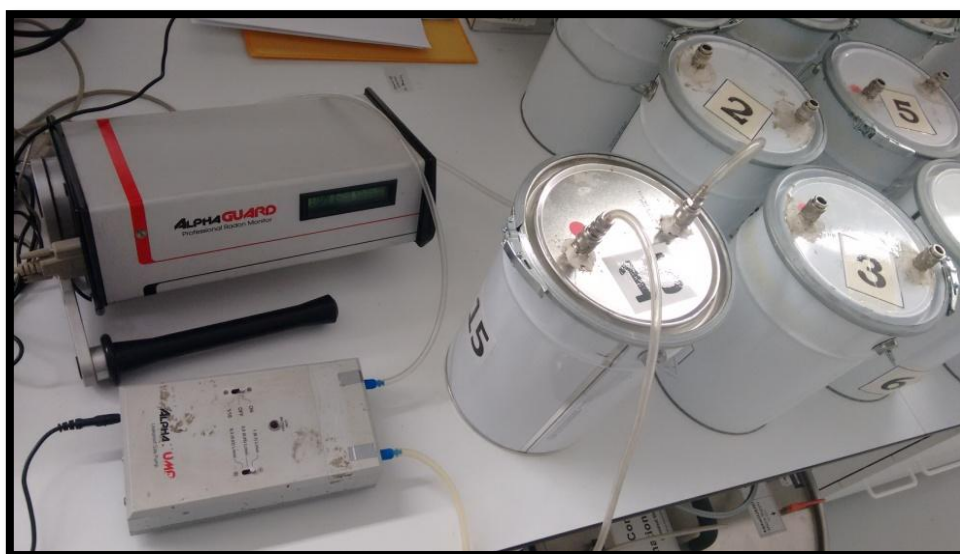
Figura 21 - Imagem representativa do medidor AlphaGuard e bomba de gás acoplados ao recipiente metálico onde está inserida a amostra.
