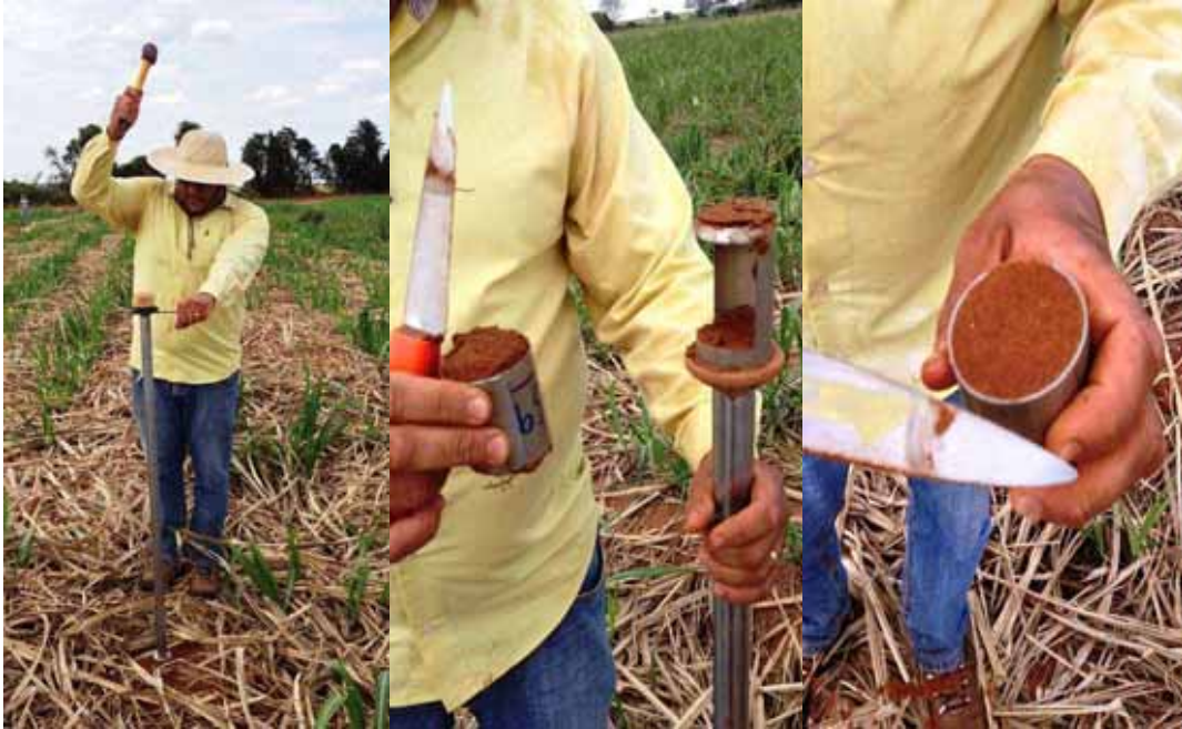
Figura 10. Coleta das amostras indeformadas
