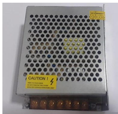
Figura 15 - Fonte de alimentação 12 V / 10 A.
