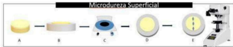
Figura 4 - Desenho esquemático das etapas para avaliação de microdureza superficial
