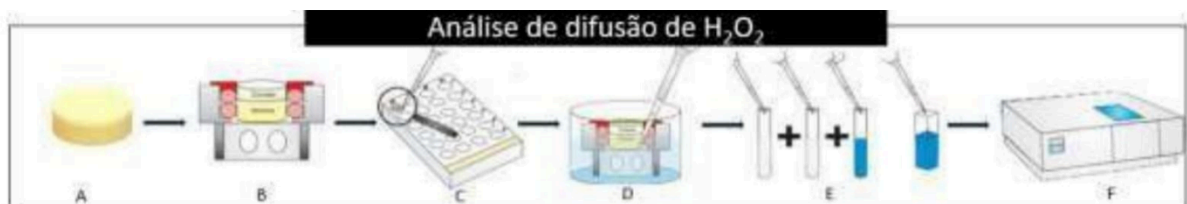
Figura 6- Desenho esquemático das etapas para coleta de peróxido de hidrogênio difundido
