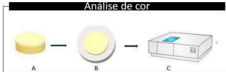
Figura 5 - Desenho esquemático das etapas para realização da análise de cor em espectrofotômetro de bancada
