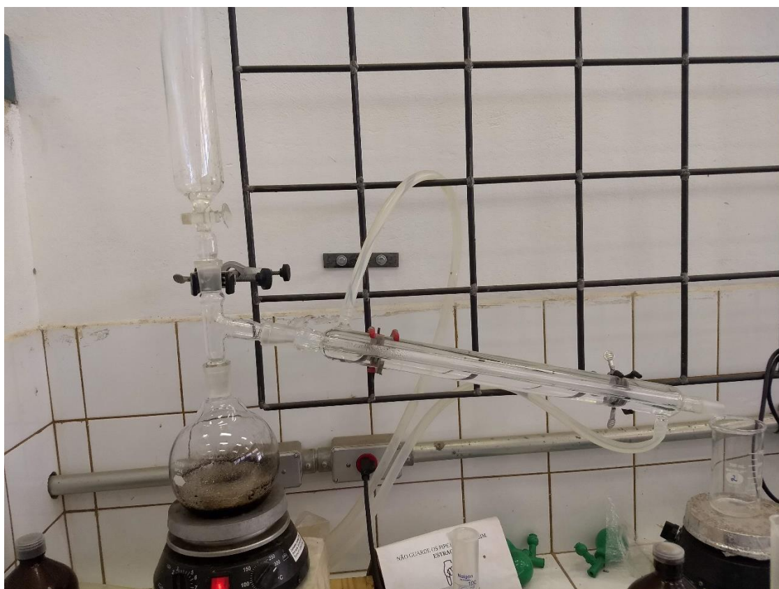
Figura 15 – Destilação no método volumétrico.
