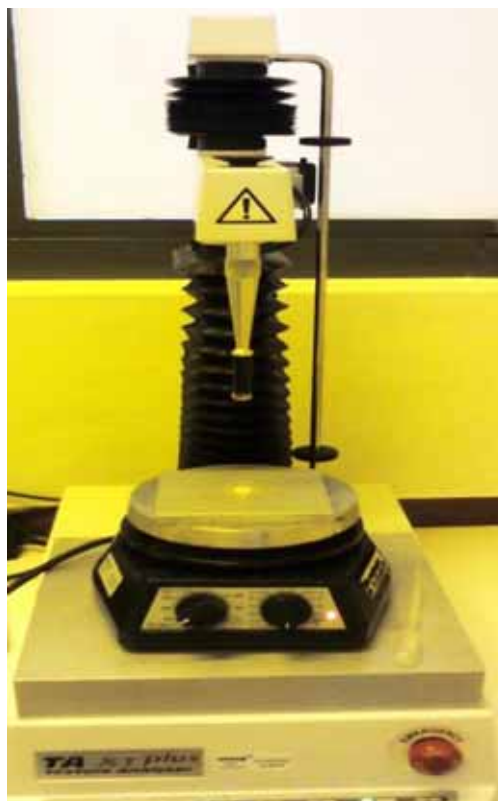
Figura 5 - Analisador de textura TA.XT plus usado para avaliar a força adesiva dos polímeros e NPs.
