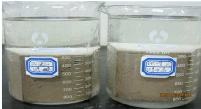
Figura 3: Amostra de solo cimento em ambiente alcalino
