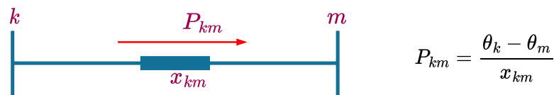
Figura 1: Fluxo de potência aproximado em uma linha de transmissão
