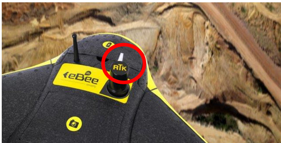
Figura 2. Aeronave eBee RTK (AgEagle, Suíça) com antena receptora GNSS RTK em destaque. Fonte: SphereDrones (2023).
