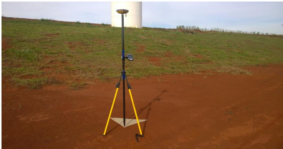
Figura 1. GNSS HIPER (Topcon, Japão) utilizado no trabalho, rastreando as coordenadas de um ponto de controle/verificação. Fonte: O próprio autor.
