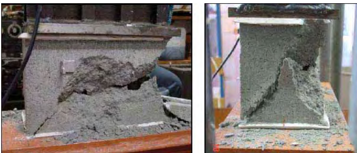
Figura 4.5- Modo de ruptura dos blocos (fonte: LOGULLO (2006))
