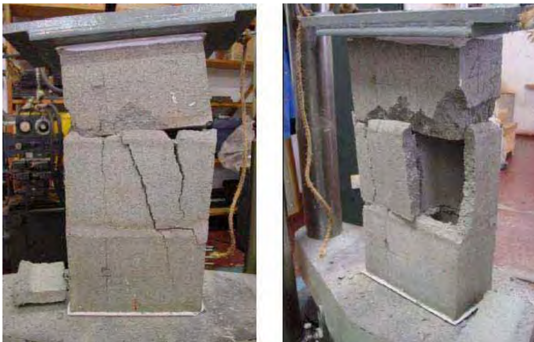
Figura 4.10- Modo de ruptura dos prismas vazios (fonte: LOGULLO (2006))
