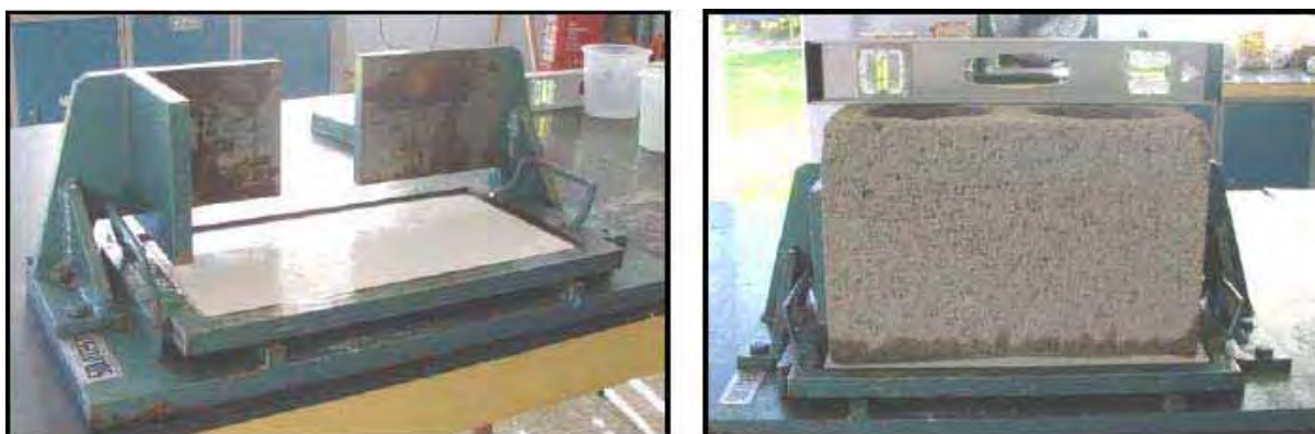
Figura 4.1- Detalhe do capeador metálico e capeamento dos blocos (fonte: LOGULLO (2006))
