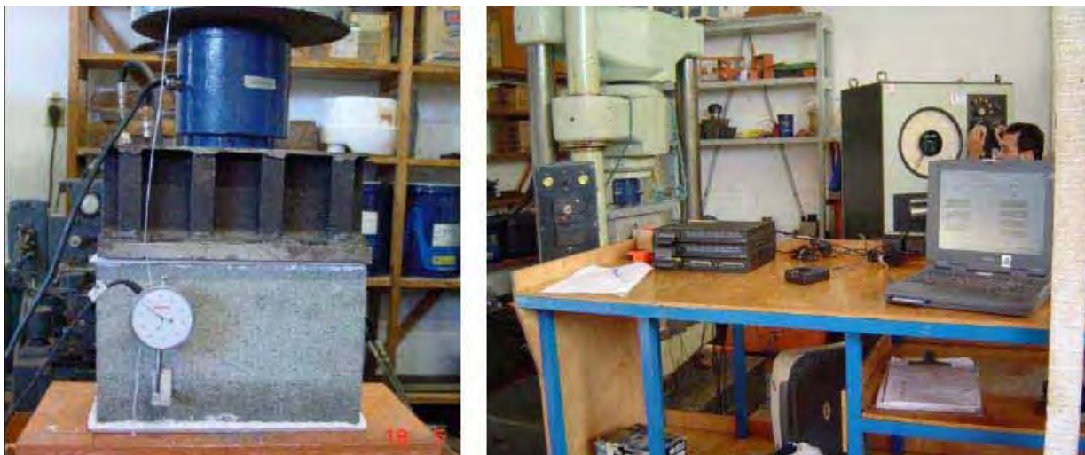
Figura 4.4 - Posicionamento da célula de carga e sistema de aquisição de dado (fonte: LOGULLO (2006))
