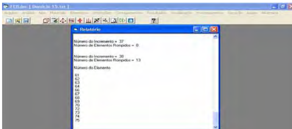
Figura 8.6- Número de cada elemento rompido no incremento 38
