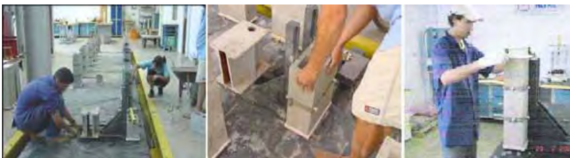
Figura 4.6- Etapas de confecção dos prismas (fonte: MAURICIO (2005) e LOGULLO (2006))
