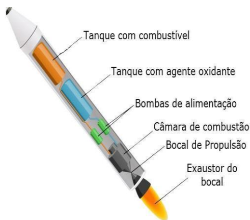
Figura 1: Diagrama esquemático explicado de um foguete com sistema de combustível líquido.
