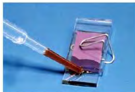
Figura 16: Montagem da Célula Fotovoltaica (Azevedo, M.; Cunha, A., sem data)
