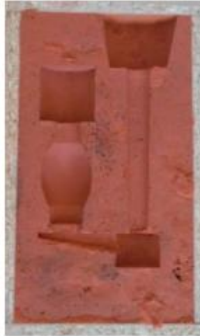
Figura 12 – Molde final para fundição em areia
