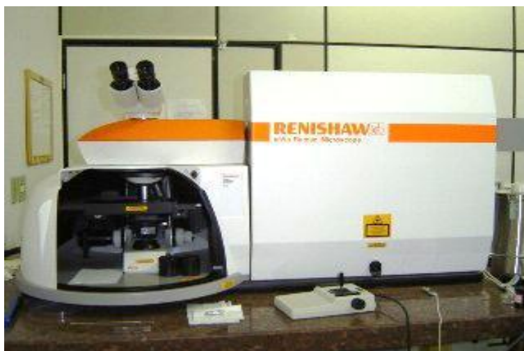
Figura 19 - Espectrômetro micro-Raman Renishaw inVia do Laboratório de Filmes Nanoestruturados e Espectroscopia do Departamento de Física, Química e Biologia – UNESP, Presidente Prudente.
