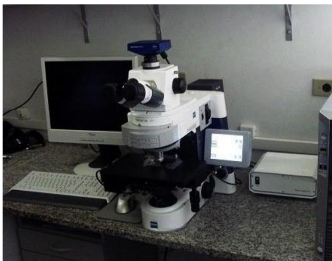
Figura 12 - Microscópio óptico Carl ZEISS® Imager M1.m do Laboratório de Microscopia do Departamento de Física, Química e Biologia – UNESP, Presidente Prudente. Equipamento utilizado para obtenção das densidades superficiais de traços de fissão espontâneos e induzidos e no imageamento óptico dos grãos de zircão nas análises de caracterização
