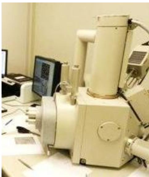
Figura 17 - Microscópio Eletrônico de Varredura FEI Quanta 450 com detector GATAN Chroma-CL do Laboratório de Catodoluminescência do Instituto de Geociências – UnB.
