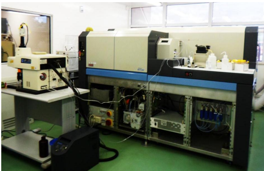
Figura 14 - Espectrômetro de massa LA-MC-ICP-MS Thermo Finnigan Neptune Multicollector™ com microsonda New Wave UP213 Nd:YAG ( \lambda = 213 nm) acoplada utilizado para datação U-Pb in situ em zircões no Laboratório de Geocronologia do Instituto de Geociências – UnB.
