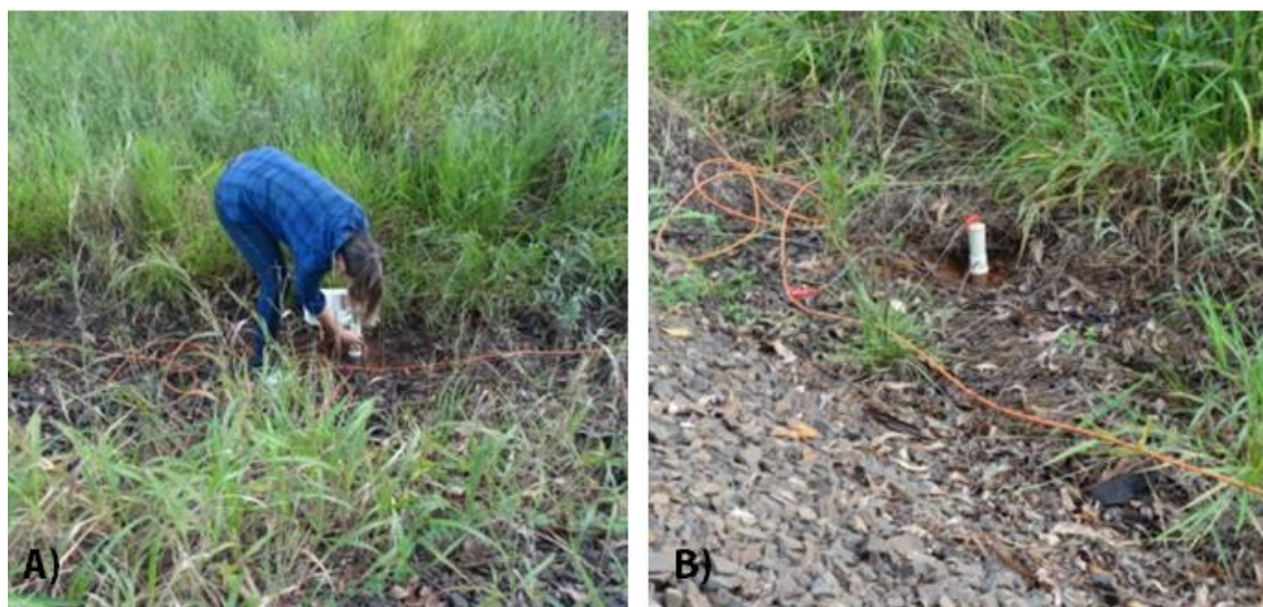
Figura 18. Instalação dos equipamentos em campo. A) Preenchimento do eletrodo com solução de sulfato de cobre ( \text{CuSO}_4 ); B) Cabos de corrente conectados aos eletrodos
