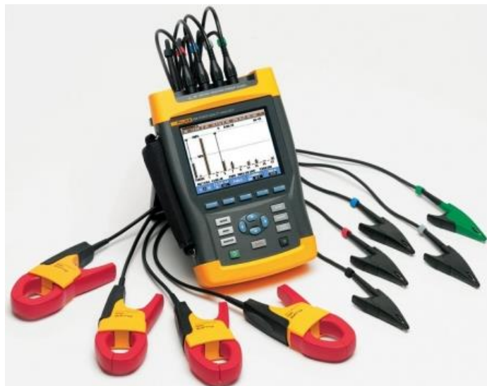
Figura 26. FLUKE 435, analisador de qualidade de energia
