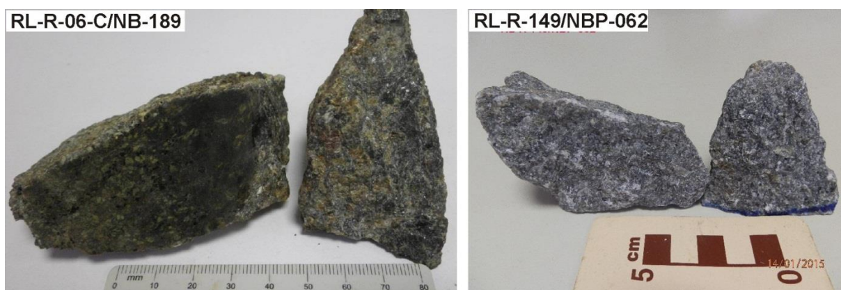
Figura 54 - Amostras de mão do litofácies flogopita-apatita-olivina metacarbonatito, com cristais disseminados de apatita (esverdeada) e de minerais ferro-magnesianos (amarronzada) em matriz carbonática, utilizadas na confecção de lâmina delgada e lâmina delgada polida.
