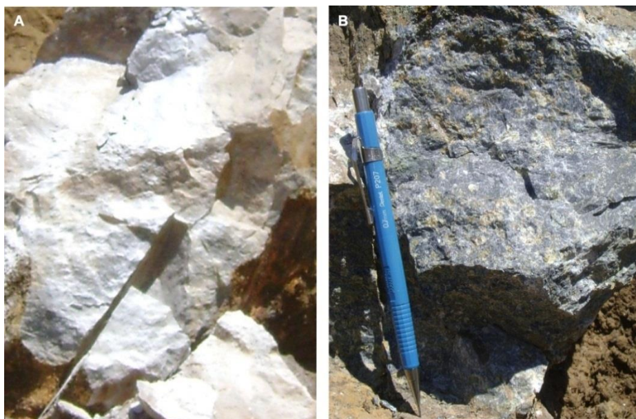
Figura 37 - Fotografias de detalhe de duas faciologias distintas em afloramentos dentro da mina de fosfato: (A) apatita metacarbonatito e (B) flogopita-apatita-olivina metacarbonatito.
