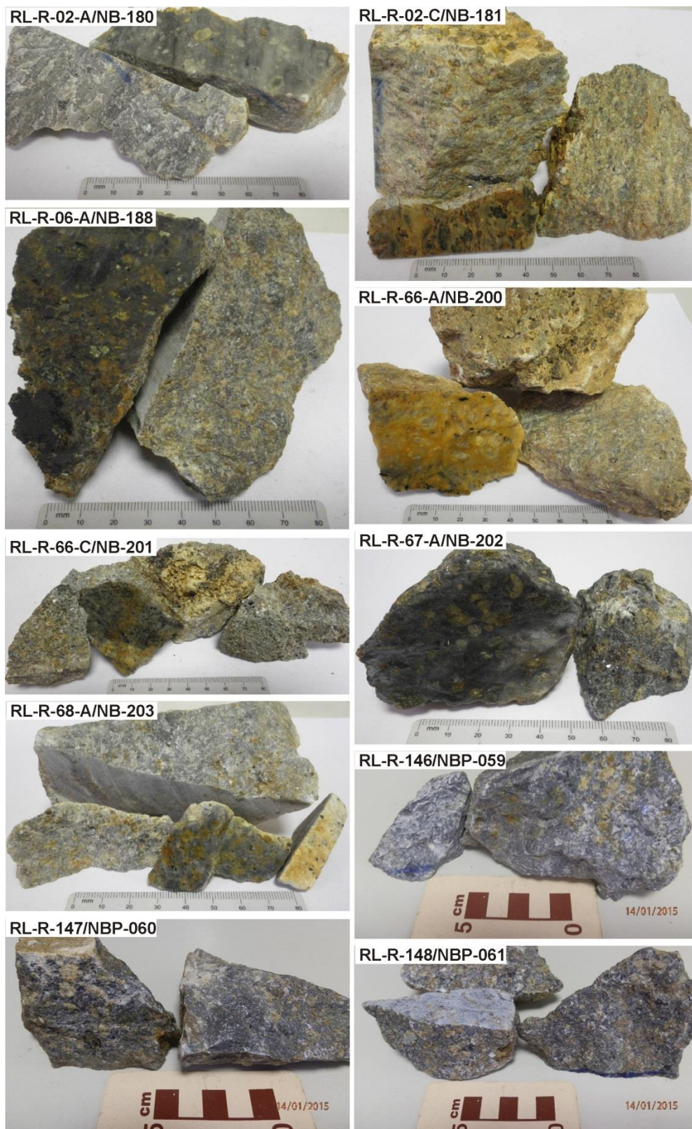
Figura 50 - Amostras de mão do litofácies meta olivina-apatita metacarbonatítica, com megacristais de apatita (cor esverdeada/amarelada, predominante) e de minerais ferro-magnesianos (cor marrom escura/preta), utilizadas na confecção das lâminas delgadas e lâminas delgadas polida.
