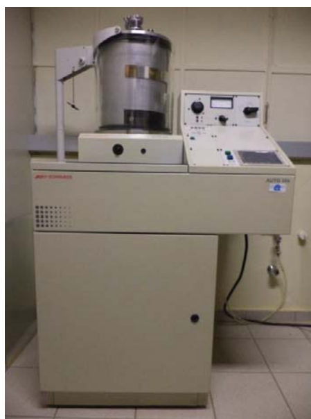
Figura 4.1.5 - Evaporadora de metais, modelo Auto 306 Coater ; fabricante BOC EDWARDS .
