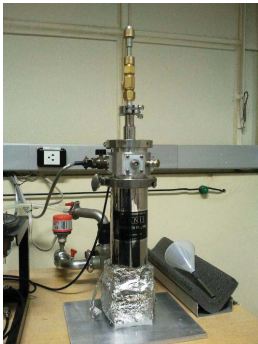
Figura 4.2.2 – Equipamento criogênico JANIS VPF-100 utilizado para as medidas a baixas temperaturas.
