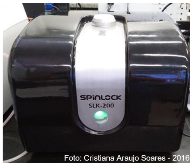
Figura 18 - Aparelho utilizado para determinação do teor de óleo, TD-NMR, em espectrômetro (SLK-SG-200-SpinLock Magnetic Resonance Solutions)
