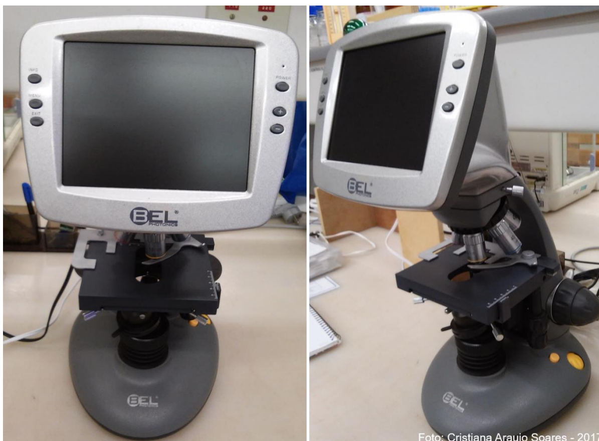
Figura 20 - Microscópio Biológico BEL® Photonics Biovídeo, utilizado para contagem dos estômatos (densidade estomática)
