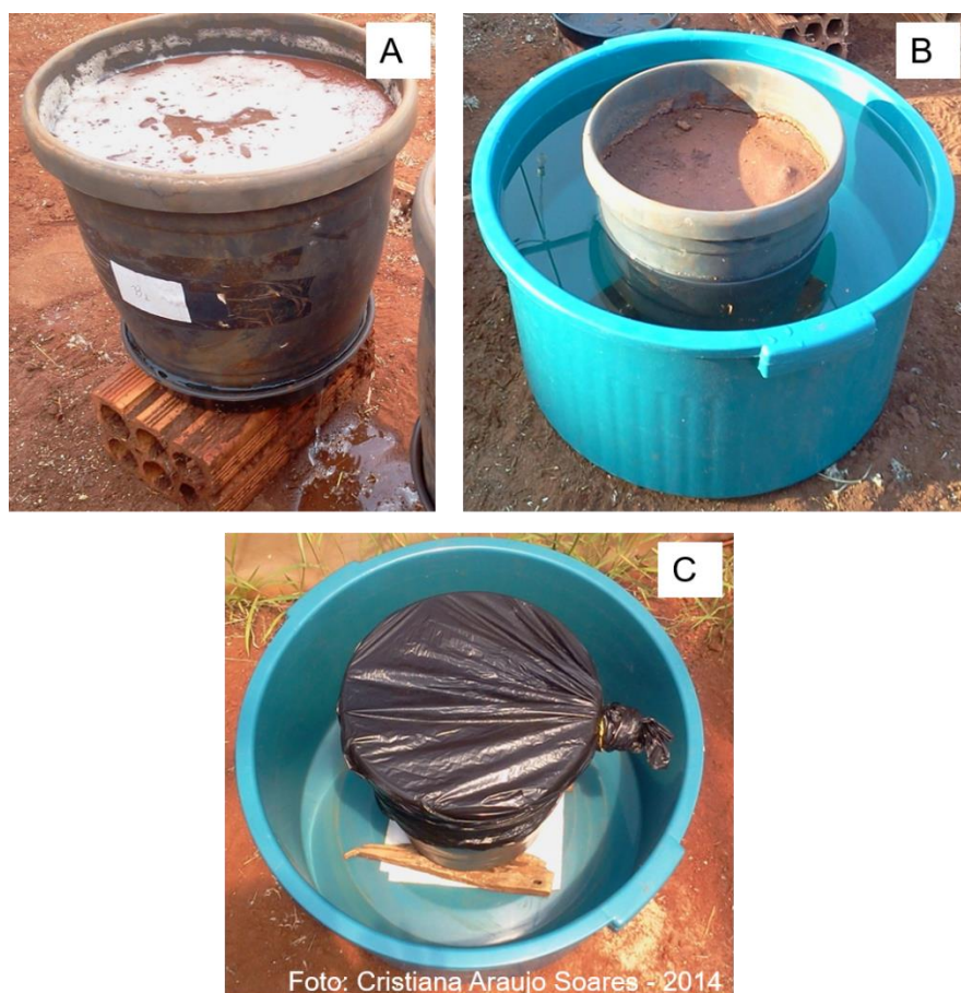
Figura 13 - Determinação da umidade do solo na “Capacidade de Campo” do vaso (“CC” vaso). Saturação e drenagem para acomodação do solo (A), saturação por capilaridade (B) e drenagem (C)
