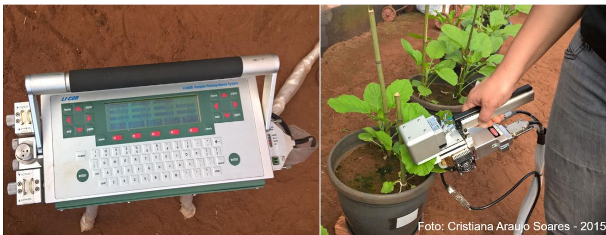
Figura 19 - Equipamento utilizado para as avaliações de eficiência fotossintética. “Infra Red Gas Analyser - IRGA”, modelo LI-6400, LI-COR
