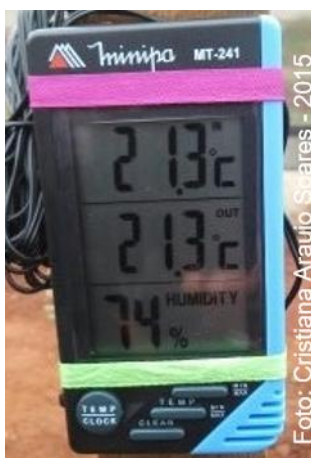
Figura 4 - Termo-higrômetro digital utilizado para coleta dos dados de temperatura (°C) e umidade relativa do ar (%)
