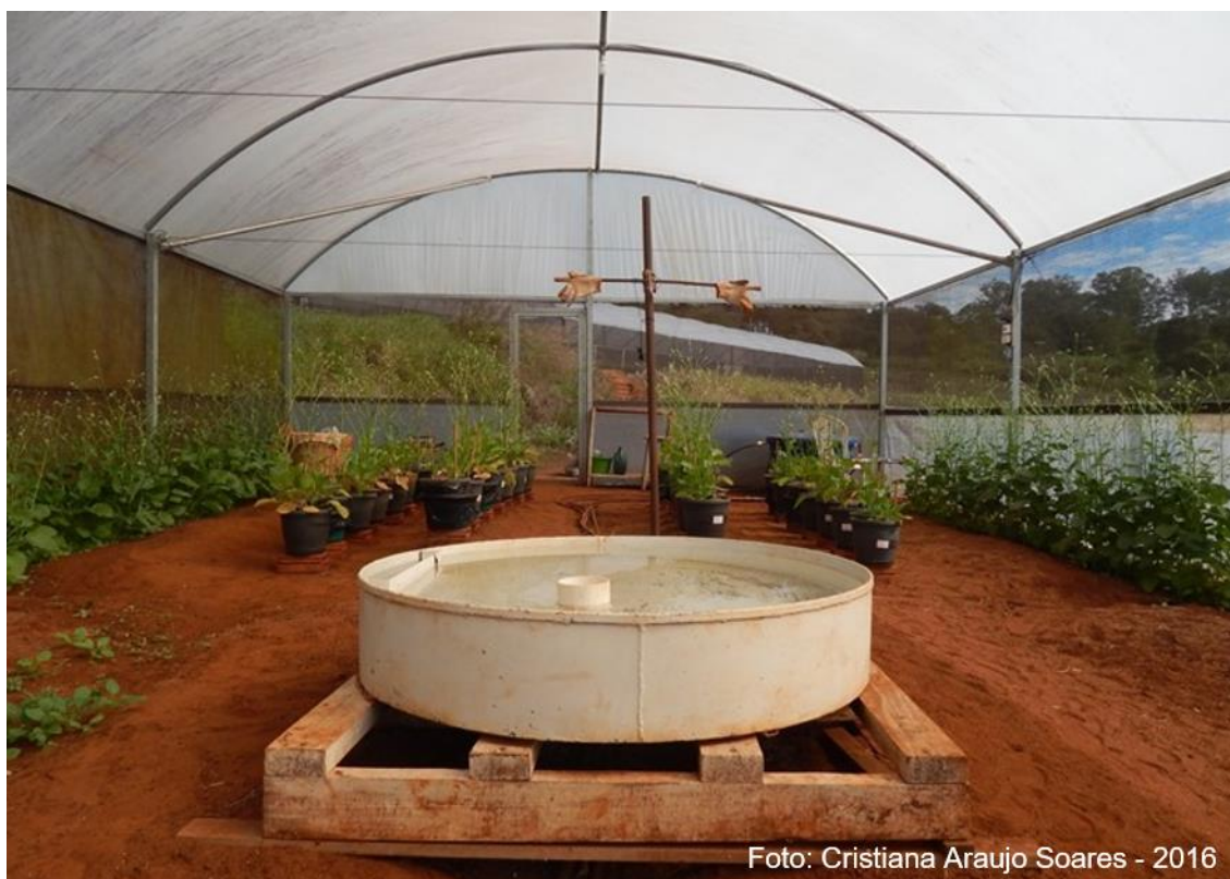
Figura 16 - Tanque Classe A instalado na área experimental
