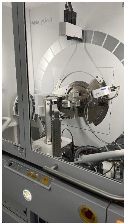
Figura 4 - Máquina Philips X'Pert da PANalytical realizando a análise de DRX
