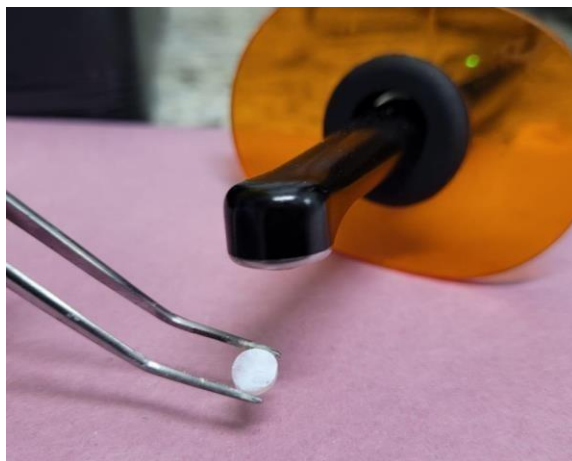
Figura 7 - Amostra fotopolimerizada após a aplicação do glaze e da pulverização da nanopartícula
