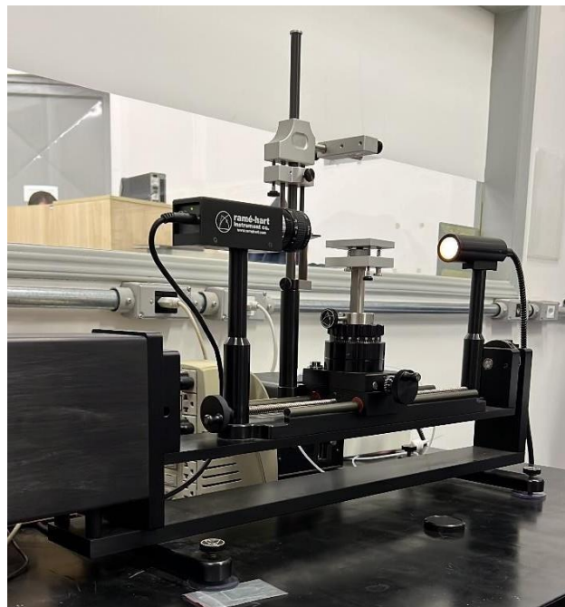
Figura 9 - Goniômetro realizando a análise da média do ângulo de contato direito e esquerdo das amostras
