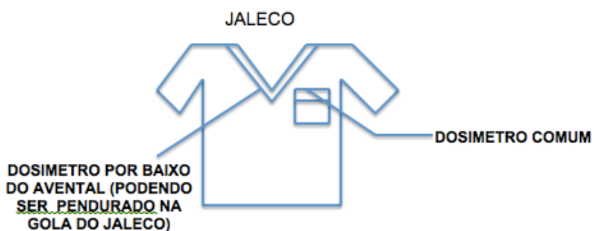
Figura 2. Posicionamento do Dosímetro OSL adicional, posicionado POR BAIXO do avental plumbífero, na altura do tórax.
