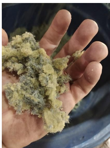
Figura 12: Esponja de Poliuretano e fibra triturada em moinho de facas
