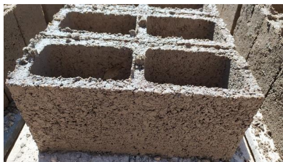
Figura 5: Bloco de concreto
