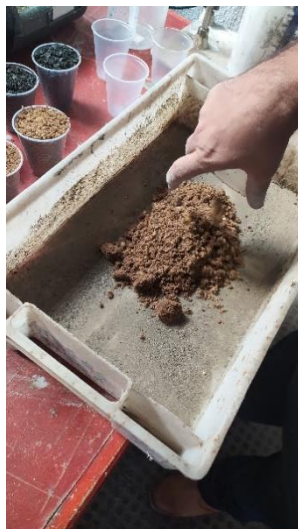
Figura 8: Preparação da massa para corpo de prova
