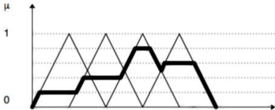
Figura 10 - Método de acumulação: combinação de consequentes a partir de várias regras
