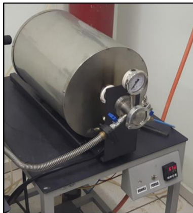
Figura 11 – Forno tubular para tratamento térmico (DMT/FEG-UNESP).
