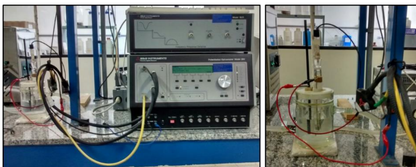
Figura 20 – Esquema de montagem do equipamento para ensaio de corrosão (DFQ/FEG-UNESP).
