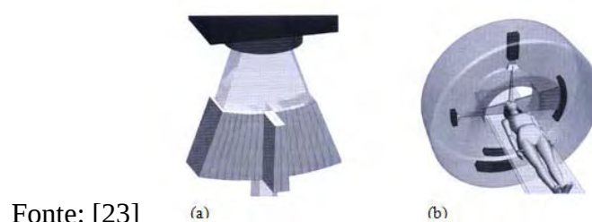
Figura 6: Feixe colimado sendo (a) Esquema prático da colimação do feixe em um aparelho de tomoterapia e (b) posicionamento do paciente no momento da aplicação da terapia.
