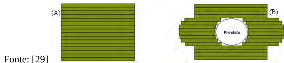
Figura 5: Sistema de colimação utilizada em aceleradores lineares para tratamento de câncer de próstata a) disposição normal e b) modelando a forma do órgão a ser tratado.
