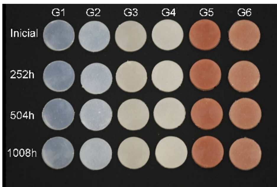
Figura 8 – Avaliação visual da estabilidade cromática nos períodos inicial e após 252, 504 e 1008 horas de envelhecimento acelerado.
