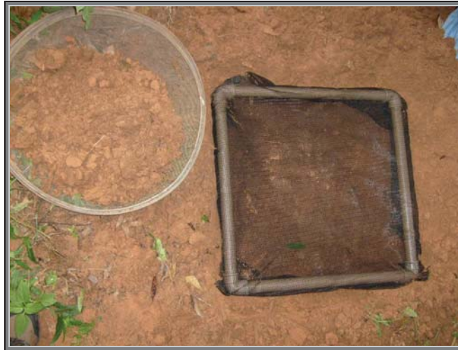
Figura 4: Instalação de parcela de areia. Estrutura de tubos de PVC e tela de sombrite.
