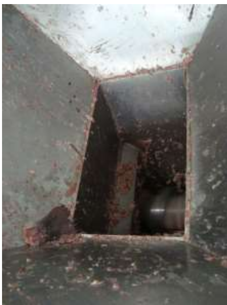
Máquina separadora de carne e ossos: entrada da carcaça
