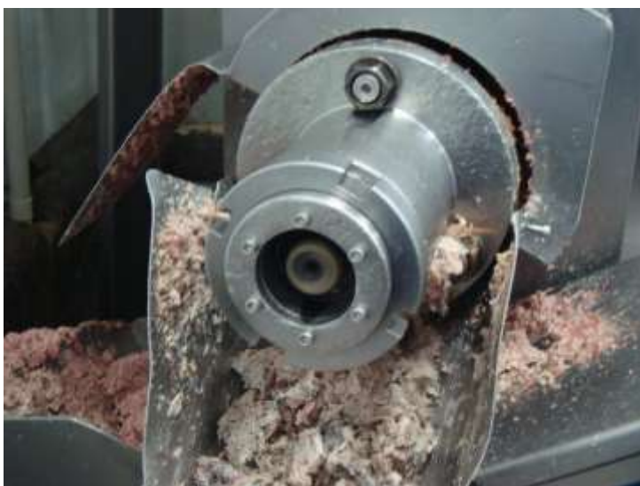
Máquina separadora de carne e ossos: saída espinhas e CMS
