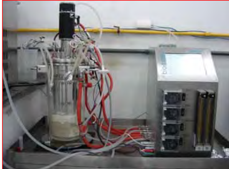
Figura 5.1 - Biorreator utilizado para fermentação que controla pH, temperatura, aeração.
