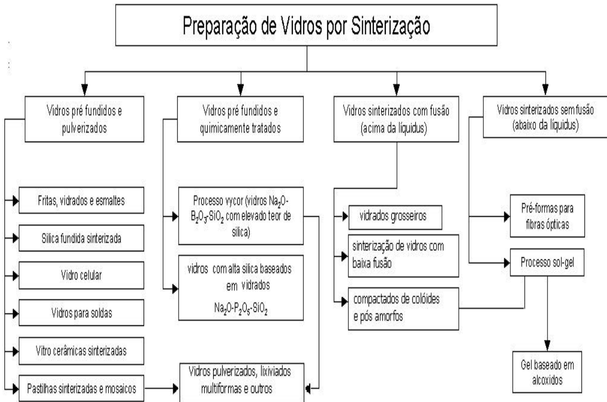
Figura 2.13. Classificação dos processos de sinterização empregados para preparação de vidros [24].
