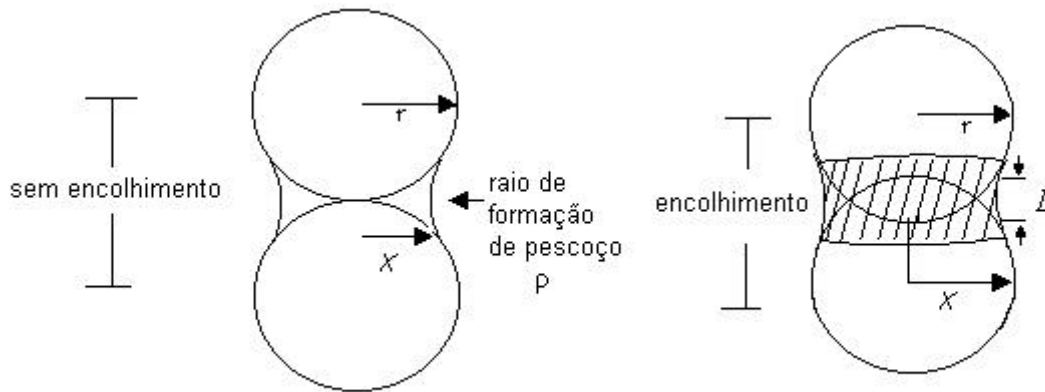
Figura 2.14. Mecanismo de sinterização: r é o raio externo e X é o raio interno do pescoço, r é o raio da partícula e L é o encolhimento.
