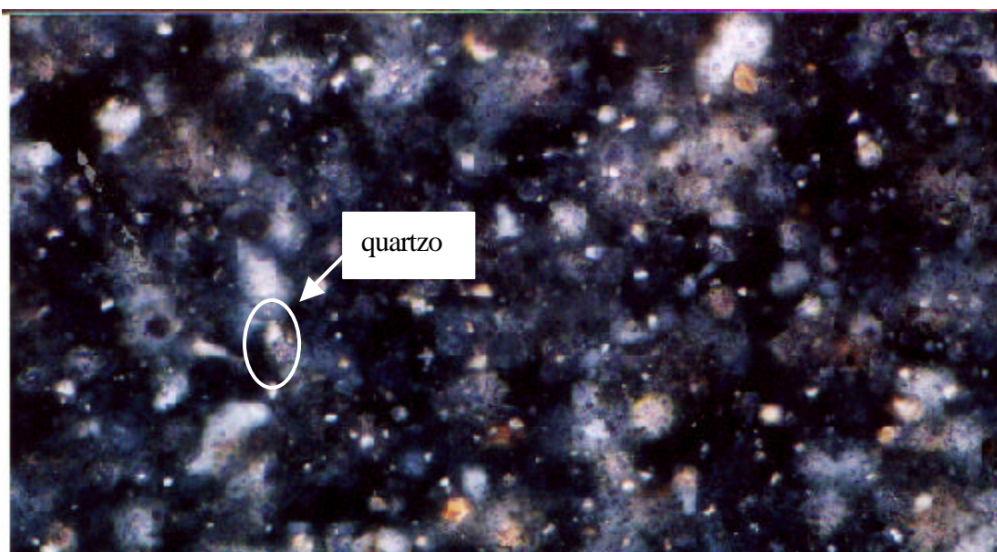
Figura 4.3. Micrografia de uma amostra de vidro com 2% de massa de resíduo. As manchas claras são atribuídas a cristais de quartzo. Imagem obtida com luz transmitida polarizada.
