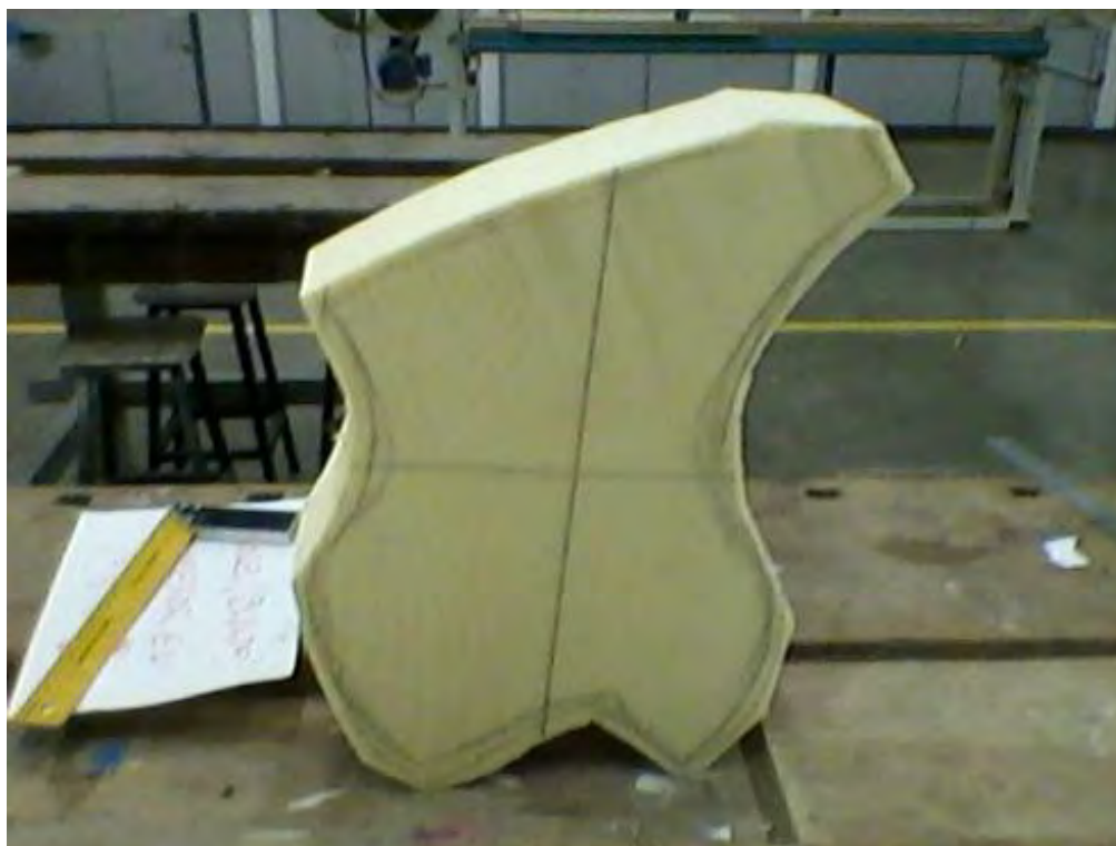
Figura 48: Trabalhos iniciais da forma final em poliuretano.
