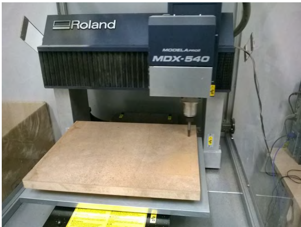
Figura 68: Prototipagem na Roland MDX-540, início.
