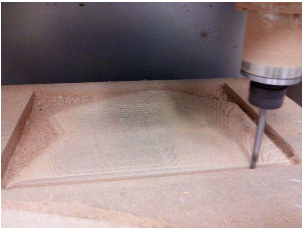
Figura 70: Prototipagem na Roland MDX-540, outra vista.
