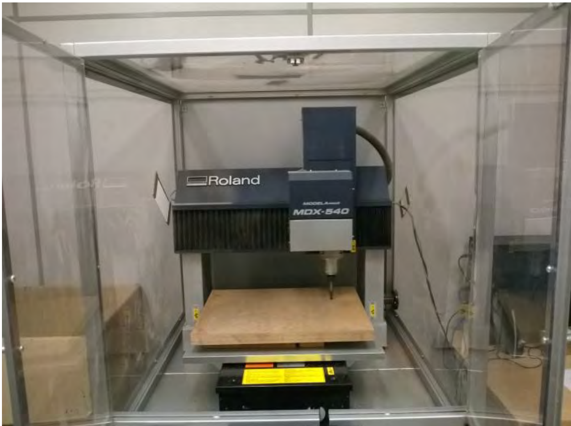
Figura 67: Prototipagem na Roland MDX-540, com bloco de MDF pronto para usinagem.
