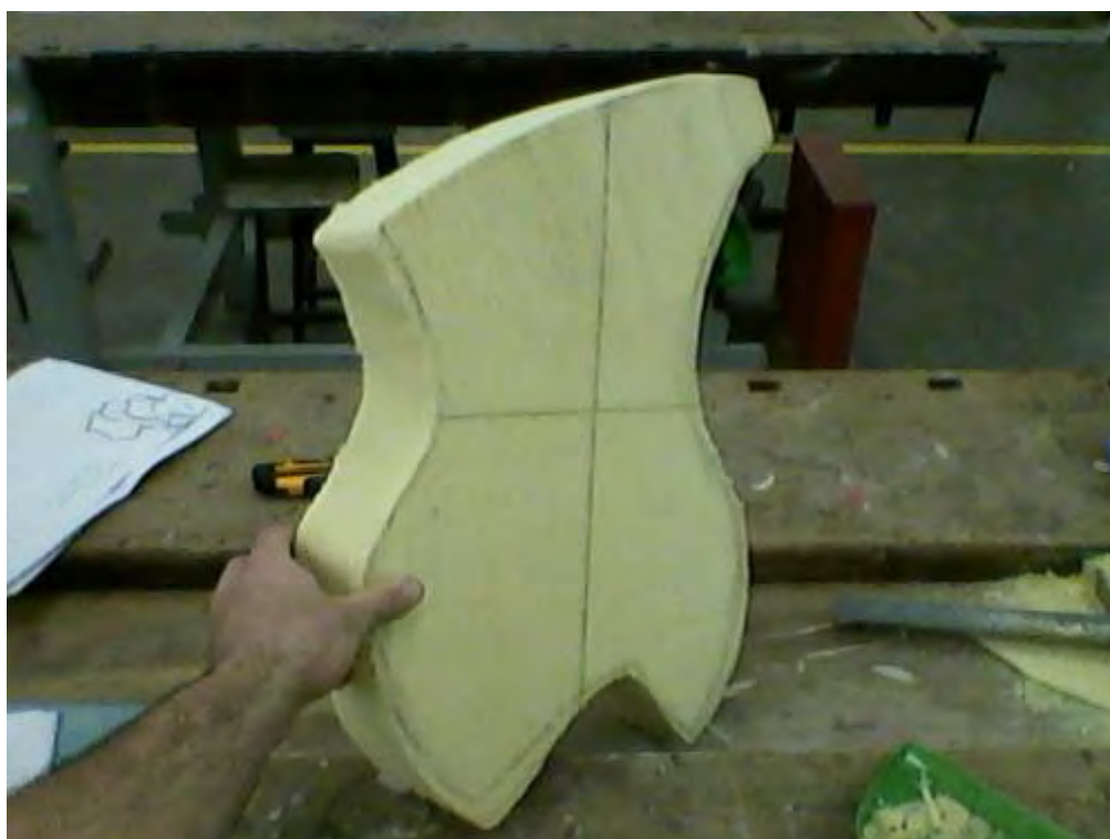
Figura 49: Trabalhos iniciais da forma final em poliuretano, com melhor acabamento.
