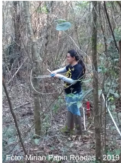
Figura 8 - Exemplo de medição de DAP com suta.
