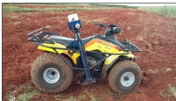
FIGURA 6. Penetrômetro eletrônico acoplado em quadriciclo
