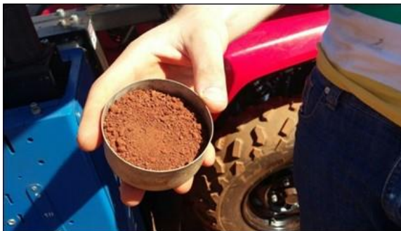
FIGURA 7. Coleta das amostras para determinação da umidade do solo
