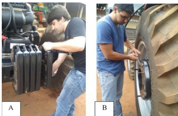
FIGURA 5. Procedimento de retirada dos lastros dianteiros (A) e traseiros (B)
