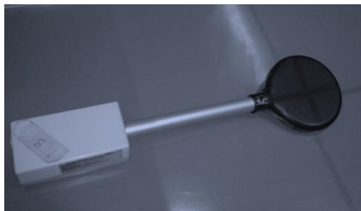
Figura 11. Câmara de ionização utilizada para realização das medidas em tempo real.
