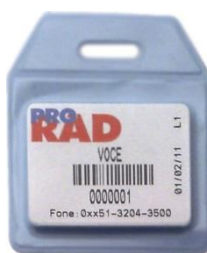
Figura 12. Exemplo de TLD utilizado para medições integradas.
